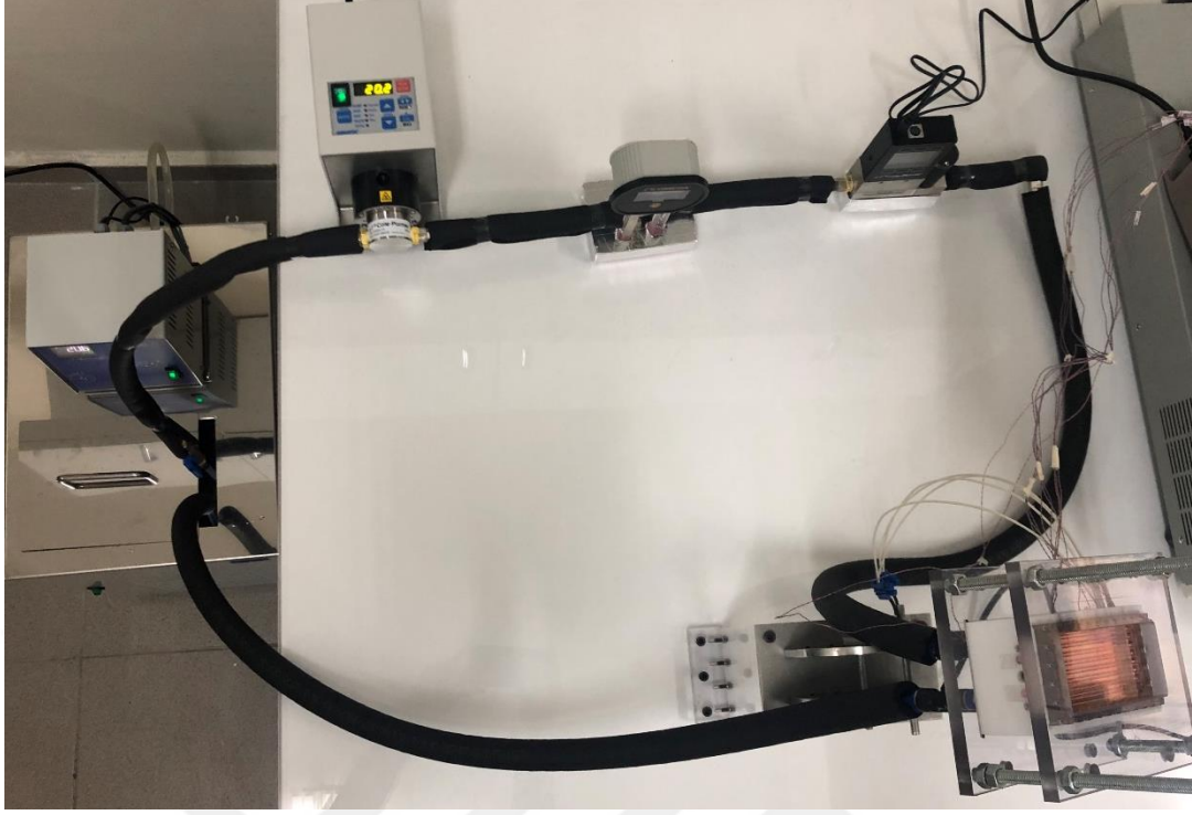
Şekil 18. Soğutucu hattının fotoğrafı.
