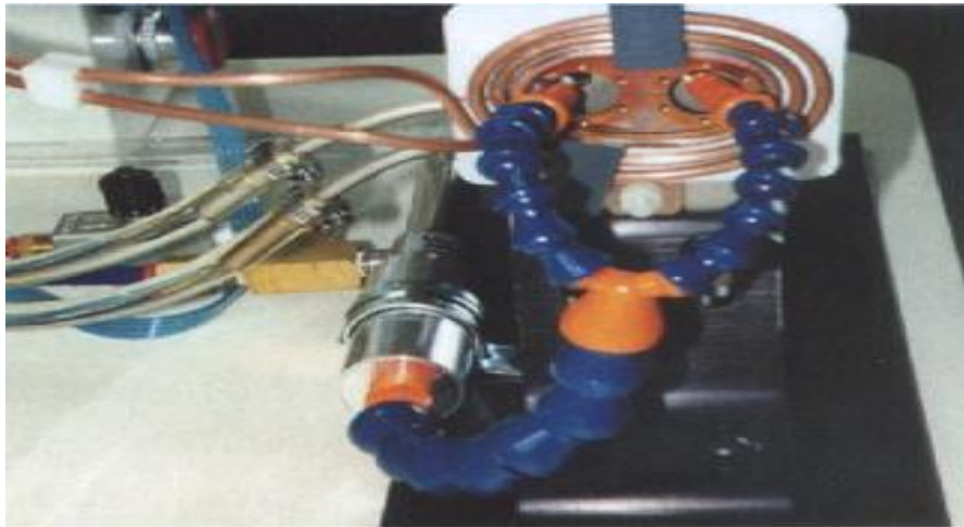
řekil 16: Tıbbi t p řekillendirme iřlemlerinde kalıbın soėutulması (URL-3, 2018).
