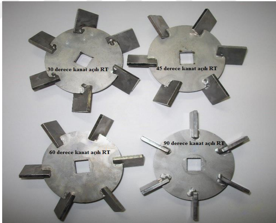
Şekil 3.1. Altı kanatlı yatayla 30°, 45°, 60° ve 90° açılı Rushton Türbinleri
