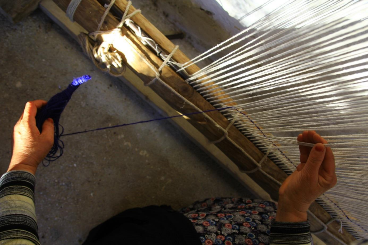
Fotoğraf. 58- Birikleme işleminin yapılışı, detay, Fotoğraf Sahibi: Ezgi Tek.
