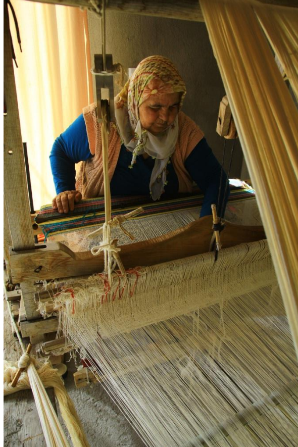
Fotoğraf. 76- Pedallı tezgâh ile dokuma işleminden detay, Fotoğraf Sahibi: Ezgi Tek.
