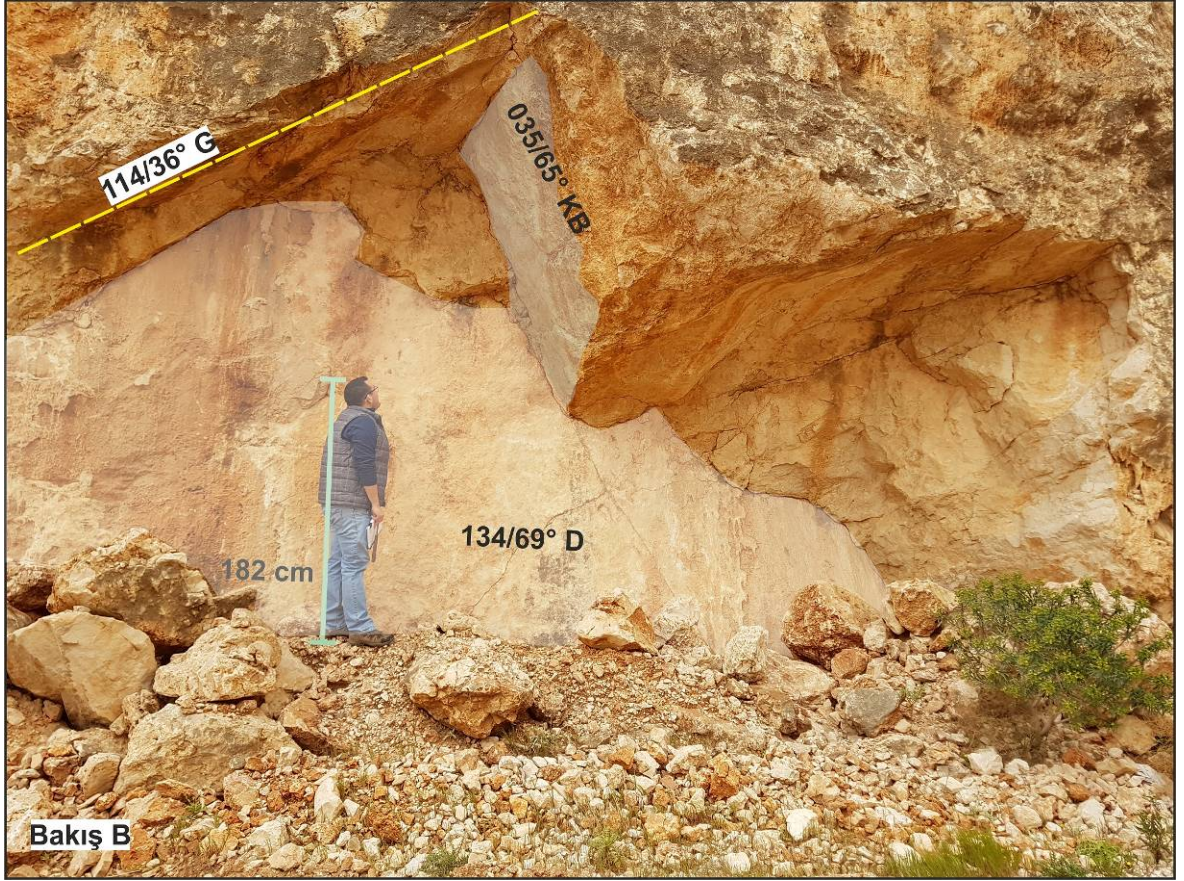
Şekil 4.2. L2 lokasyonunda kireçtaşı birimlerinde gelişen farklı eklem düzlemlerinin görünümü
