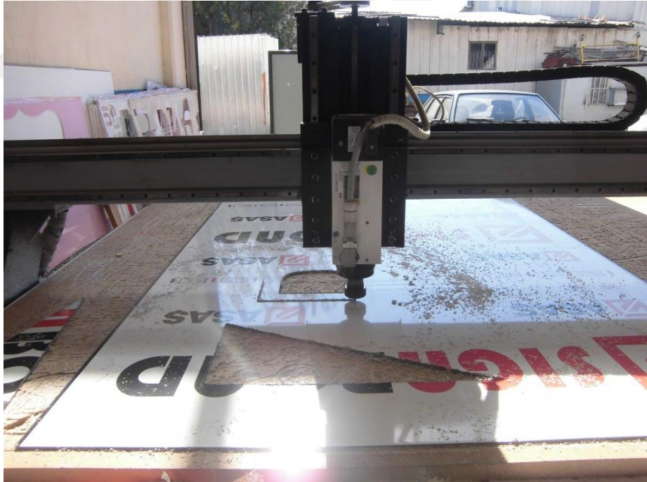
Fotoğraf 47. Cnc router makinesi tabela harf kesimi (Araştırmacı tarafından fotoğraflanmıştır)
