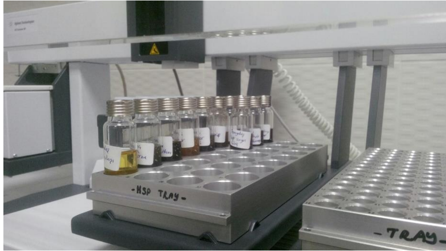
Şekil 3.16. Uçucu analitler için Headspace çalışması
