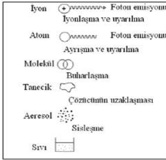
Şekil 3.14. Atomlaşma ve uyarılmanın şematik gösterimi
