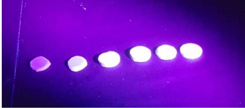
Şekil 4.58. Soldan sağa molce %0.02-0.04-0.06-0.08-0.10-0.12 Eu^{+2/+3} katkılı Si_2N_2O fosforlarının UV ışık altında görüntüsü
