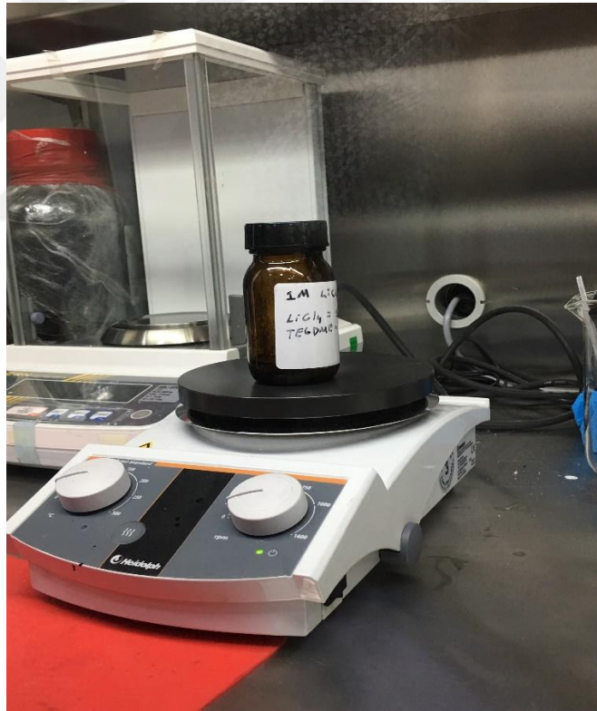
Şekil 5.11. Glovebox içerisinde sıvı elektrolit manyetik karıştırıcıda karıştırılırken
