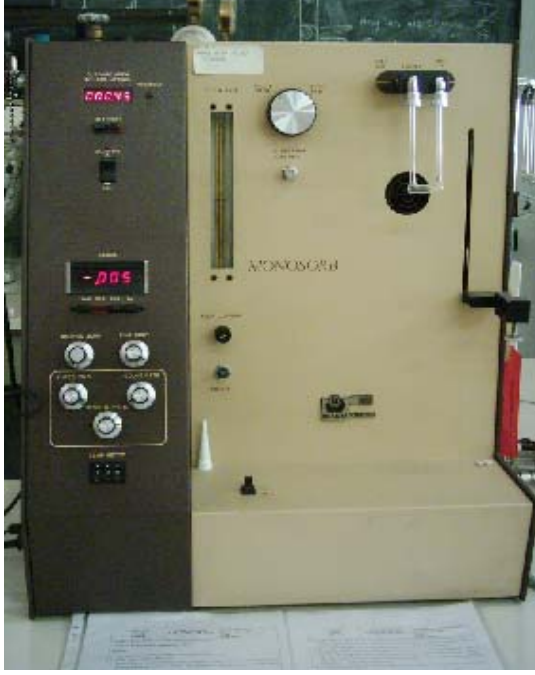
Resim 2.1. Tek nokta BET yüzey alanının belirlendiği Quantachrome Monosorb Sorptometre cihazı
