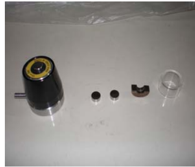
Resim 3.2. Tablet basma aparatı
