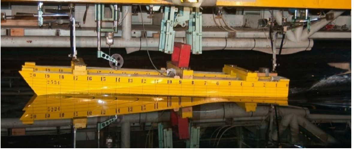
Şekil 1.2. Deney havuzunda katamaran model testi (Broglia, 2014)
