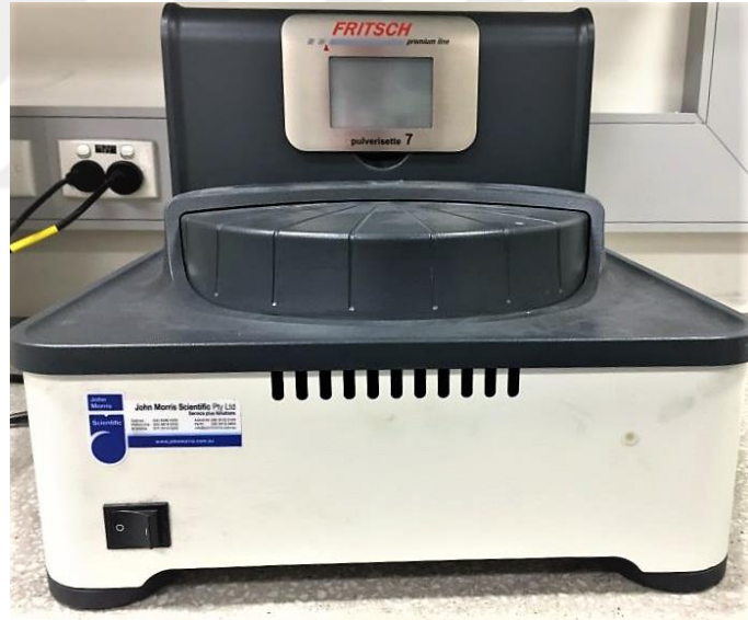
Şekil 4.4. Bilyalı değirmen (Fritsch Pulverisette 7).
