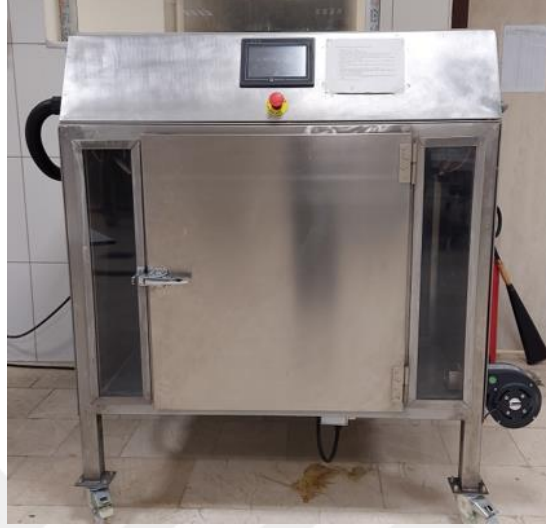
Fotoğraf 3. 2. Laboratuvar tipi tepsili kurutma dolabı.
