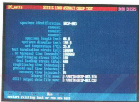
Şekil 4.5. Creep deney'i kullanım ve kontrol ekranı
