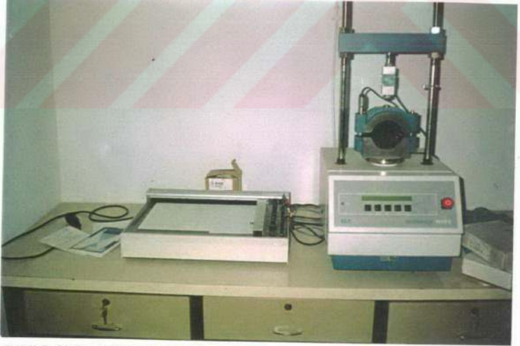
Şekil 5.6 Marshall deney cihazı ve yazıcısı
