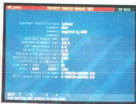
Şekil 4.2. İndirekt çekme modülü deneyi kullanım ve kontrol ekranı.
