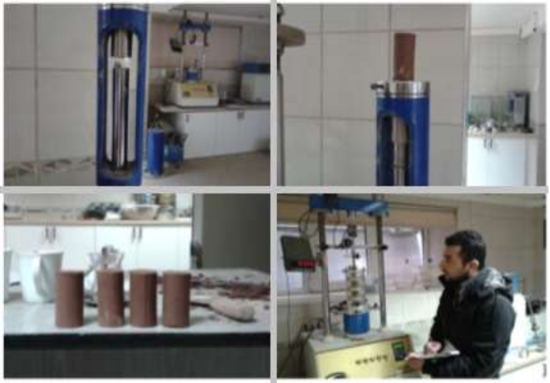
Şekil 3.2: Üç Eksenli Basınç Deneyi Çalışmaları.
