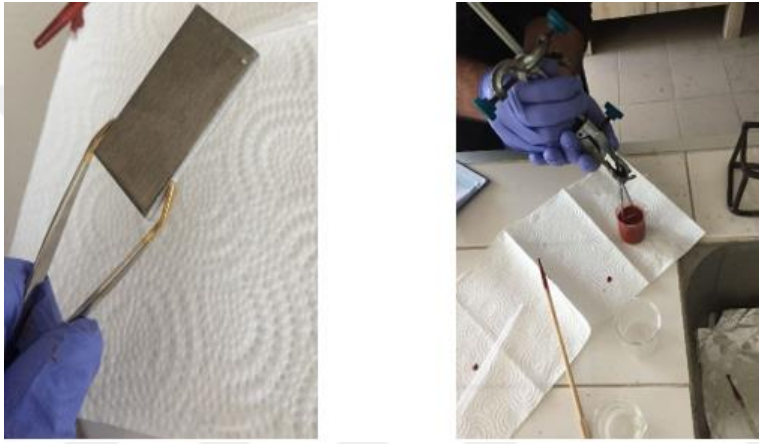
Şekil 3.3. Daldırma yöntemi ile numune elde edilmesi
