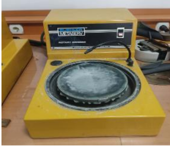
Resim 3.10 Diğer zımparalamaların yapıldığı Buehler marka zımparalama aparatı (Çankırı Karatekin Üniversitesi MYO)
