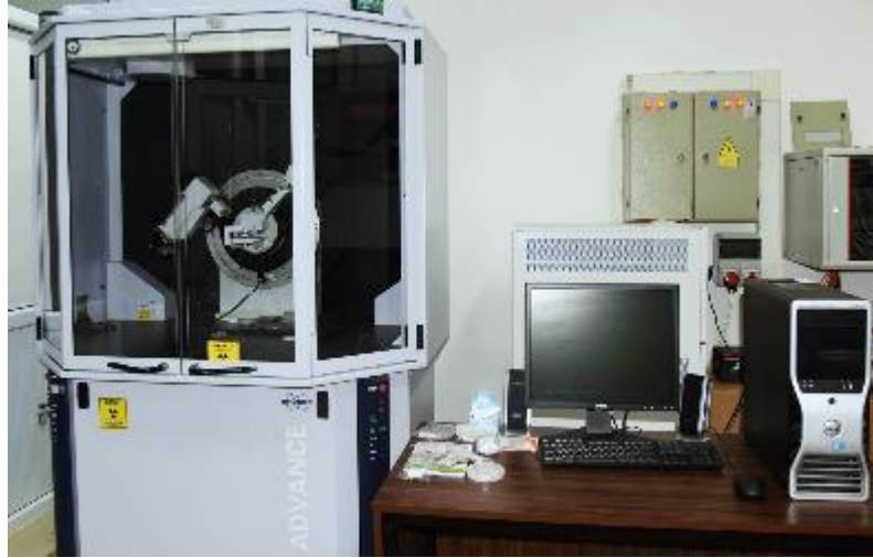
Resim 3.16 XRD cihazı (Kastamonu Üniversitesi MERLAB)
