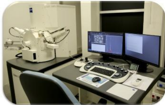
Resim 3.15 Numunelerin mikroyapısal görüntülerinin alındığı SEM cihazı (Çankırı Karatekin Üniversitesi ÇANKAM)
