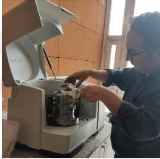
Resim 3.2 Tozların hazneye konduktan sonra sıkılarak yerleştirilmesi
