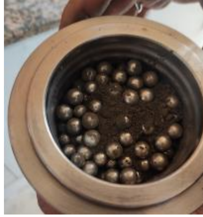
Resim 3.4 Karıştırma sonucu homojen şekilde karışan yapı
