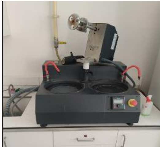
Resim 3.9 75 numaralı zımpara kullanılan nanoteknoloji labında bulunan zımparalama aparatı (Kastamonu Üniversitesi)
