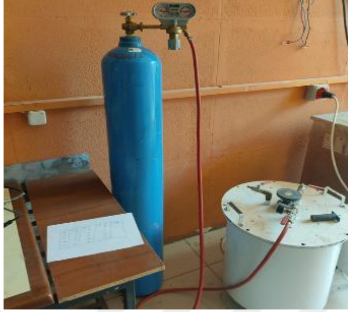
Resim 3.7 Sinter fırınının argon gazı tüpü ve numune yerleşim planı
