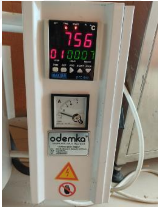
Resim 3.8 Fırının zaman ve sıcaklık ayarı kontrol ünitesi çalışma anı.
