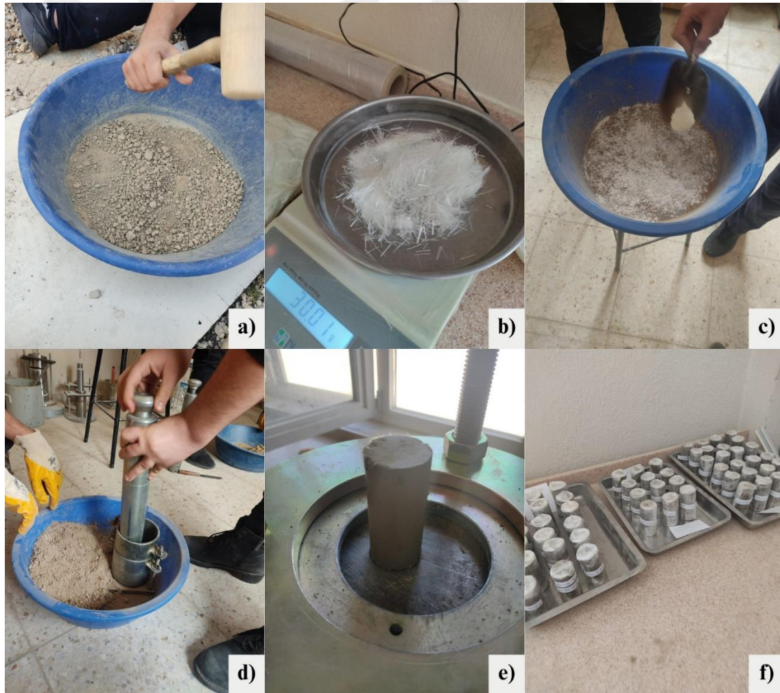
Resim 3.2 Numune alım aşamaları, a) Etüv kuru malzemenin ufalanması, b) Uygun oranda elyaf malzeme tartılması, c) Malzemelerin homojen şekilde karıştırılması, d) Standarda uygun şekilde sıkıştırma işlemi yapılması, e) Press makinasından numune alımı, f) Alınan numunelerin streçlenerek kür sürelerinde bekletilmesi
