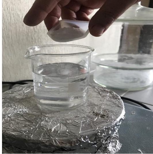
Resim 3.11 Bor Oksit destile su karışımı
