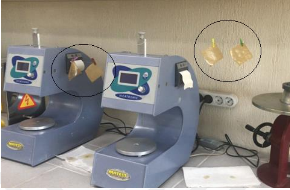
Resim 3.18 Reçine sonrası asarak kurutma yöntemi
