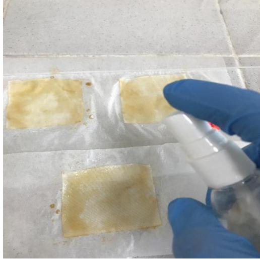
Resim 3.14 Reçine sonrası bor oksit püskürtme yöntemi
