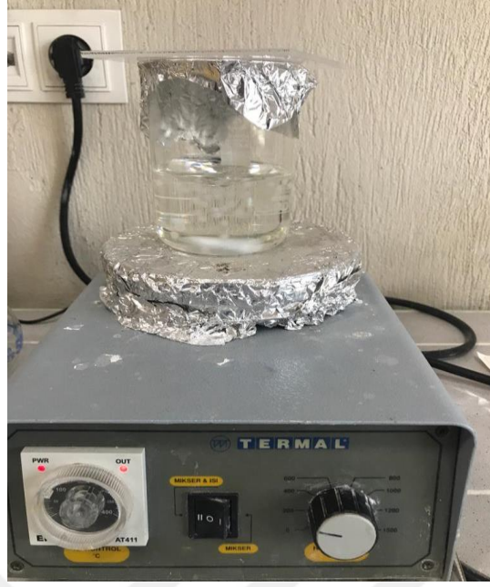
Resim 3.9 Polietilen ve toluen karışımı
