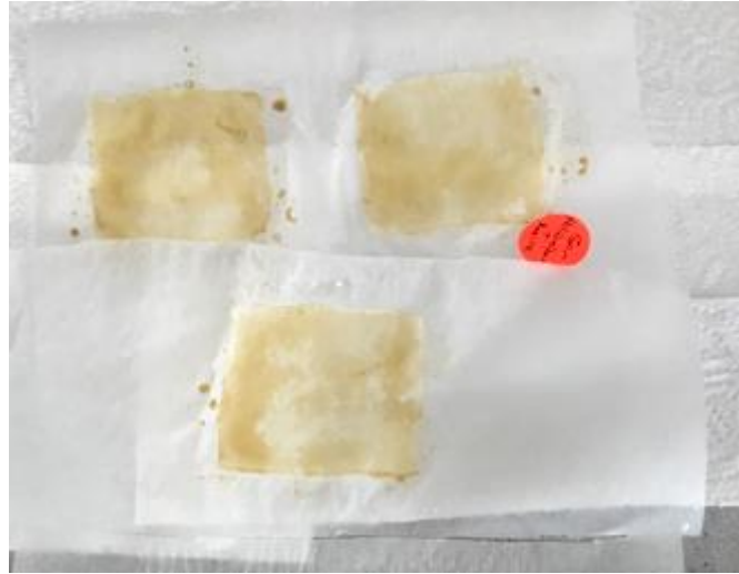
Resim 3.13 Kumaşlara kaplanan reçine + sertleştirici
