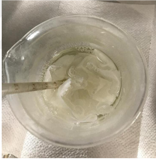
Resim 3.10 Polietilen karışımı içerisindeki kumaş numuneleri
