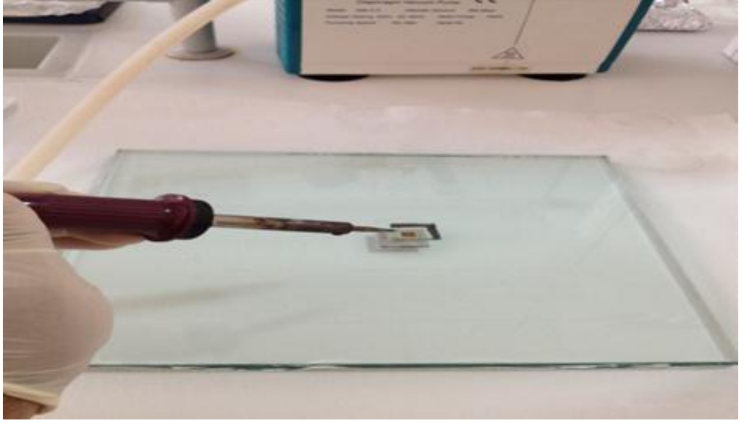
Şekil 4.8 DSSC mühürleme aşaması
