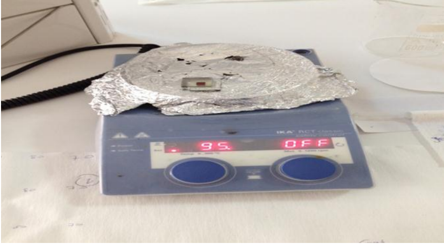
Şekil 4.5 elektrotların yapıştırılması için ısıtılması
