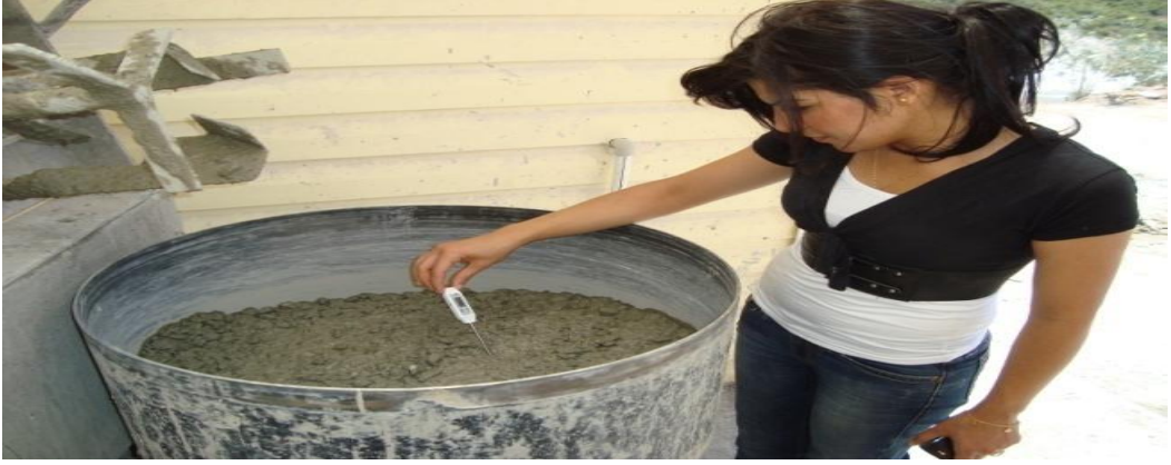
Resim 4.8 Betonun sıcaklık ölçümü
