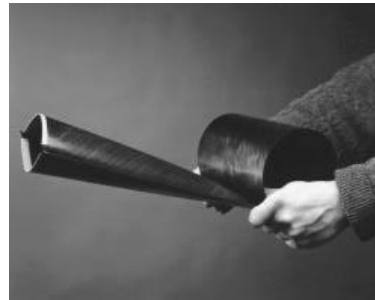
Şekil 3.2 Elastik enerji depolayabilen malzemeler (CFRP)
