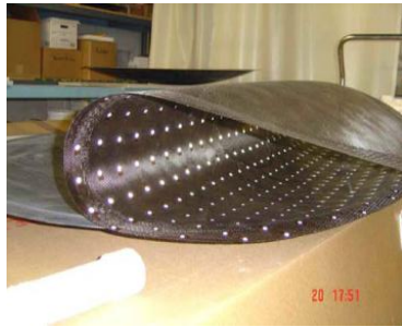
Şekil 3.2 Elastik enerji depolayabilen malzemeler (CFRP)
