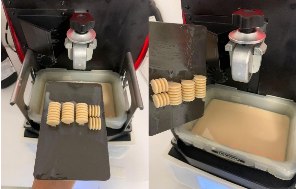
Şekil 3. 5. Üretim sonrasında örneklerin tabla üzerindeki görünümü
