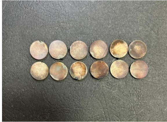
Şekil 3. 14. Altın kaplama uygulaması sonrası örnek yüzeyleri
