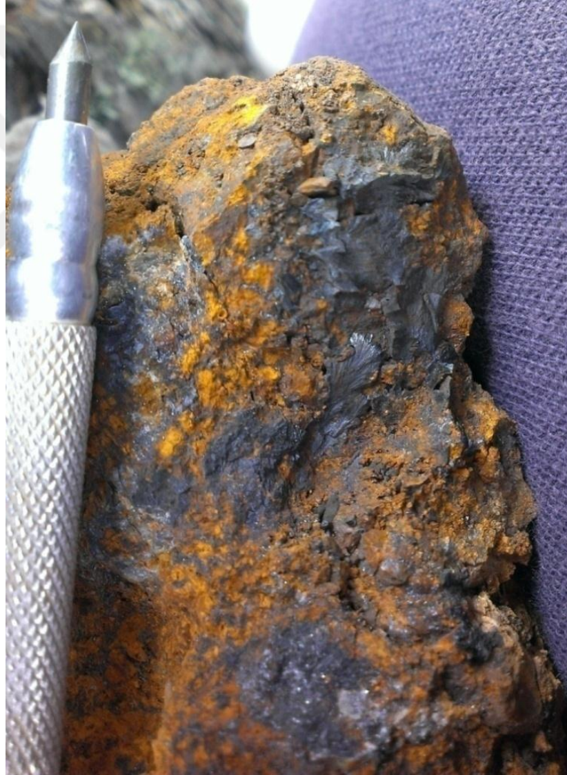
Şekil 3.6 Pb-Oksit içeriği yüksek cevher örneği.
