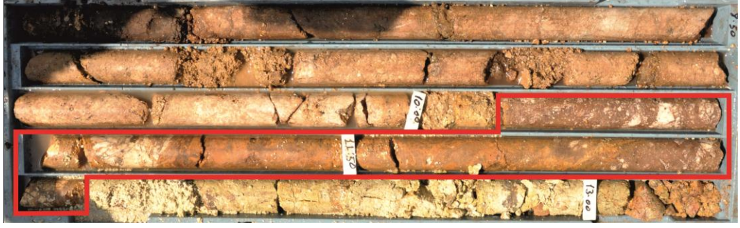
Şekil 3.5 Sondaj çalışmalarında kesilen yüksek oksitli cevher zonu (Bkz.Şekil 3.2’ de yer alan YBD-10 Nolu sondaj / 10.10 – 12.30 metre arası)
