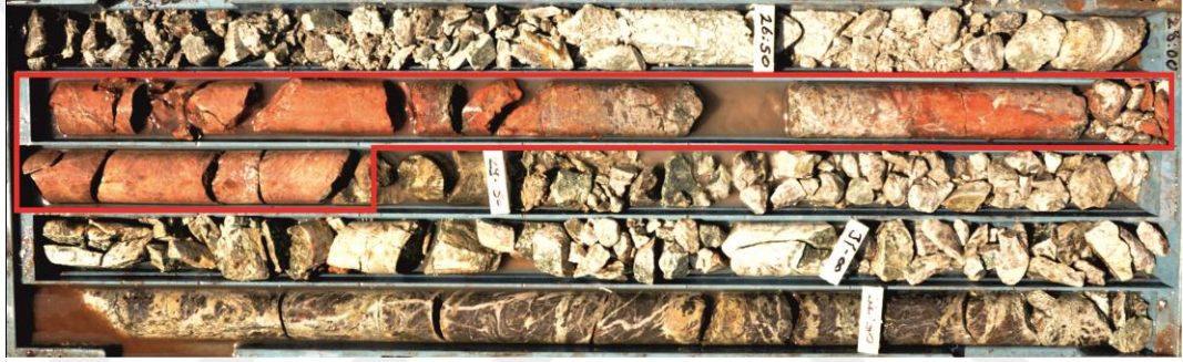
Şekil 3.12 Skarn cevherleşmesi (Bkz. Şekil 3.2: YBD-10 nolu sondaja ait 28.00 – 29.20 m. arası)
