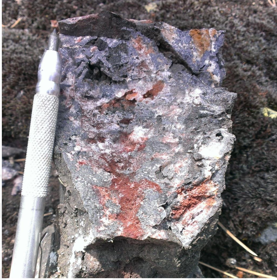
Şekil 3.3 Barit ve Fe-Oksit içeriği yüksek cevher örneği.
