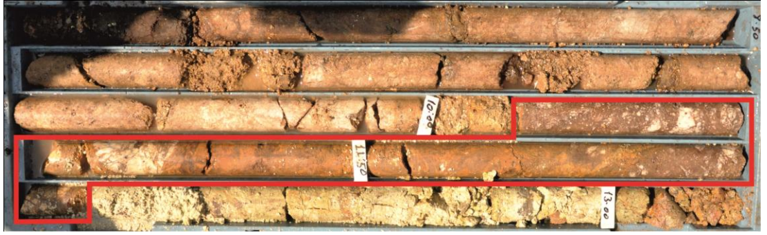
Şekil 3.4 Sondaj çalışmalarında kesilen yüksek oksitli cevher damarı.
