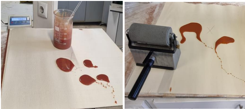
Şekil 3.8: Kaplamaların tutkal sürme merdanesi yardımıyla tutkalllanması.
