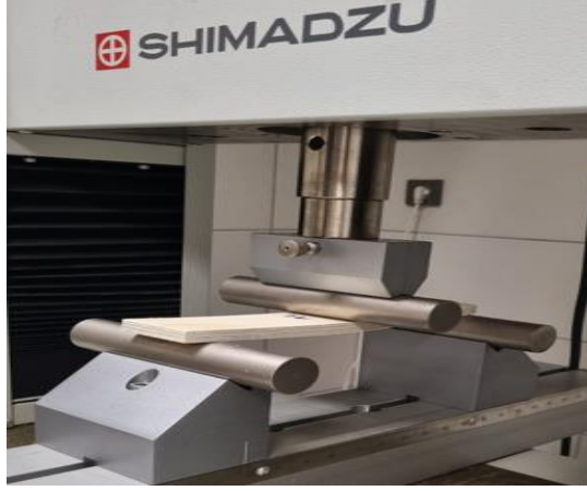
Şekil 3.11: Eğilme ve elastikiye modülü belirleme makinası.
