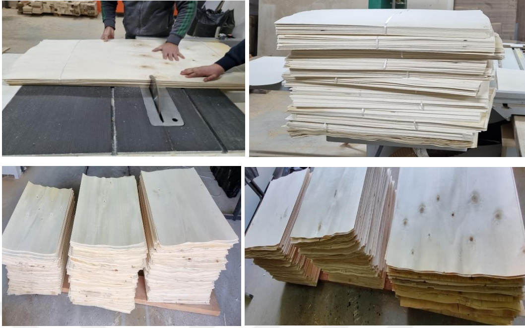
Şekil 3.2: Atölyede kaplamaların boyutlandırma ve tasnif işlemleri.
