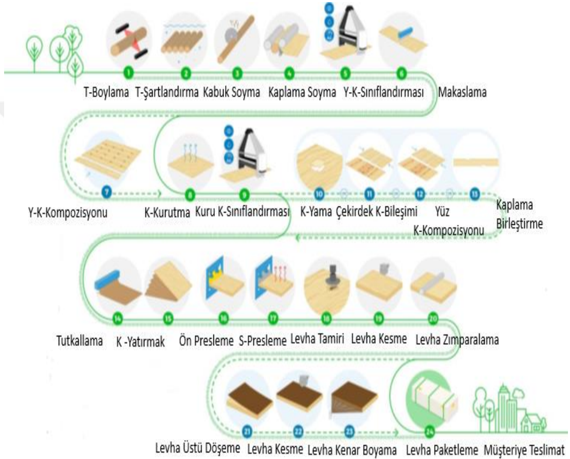
Şekil 1.7: Kontrplak üretim sürecinin şematik görünümü.
