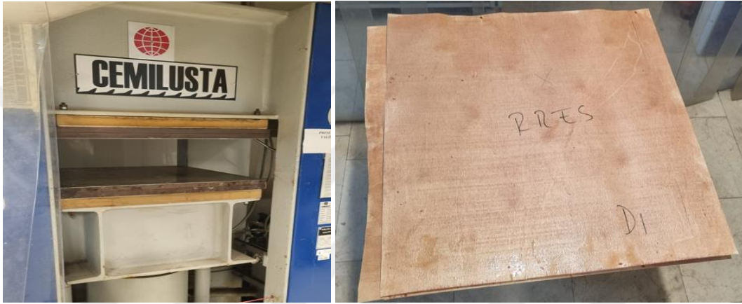
Şekil 3.9: Hazırlanan levha taslağının tek katlı preste preslenmesi.
