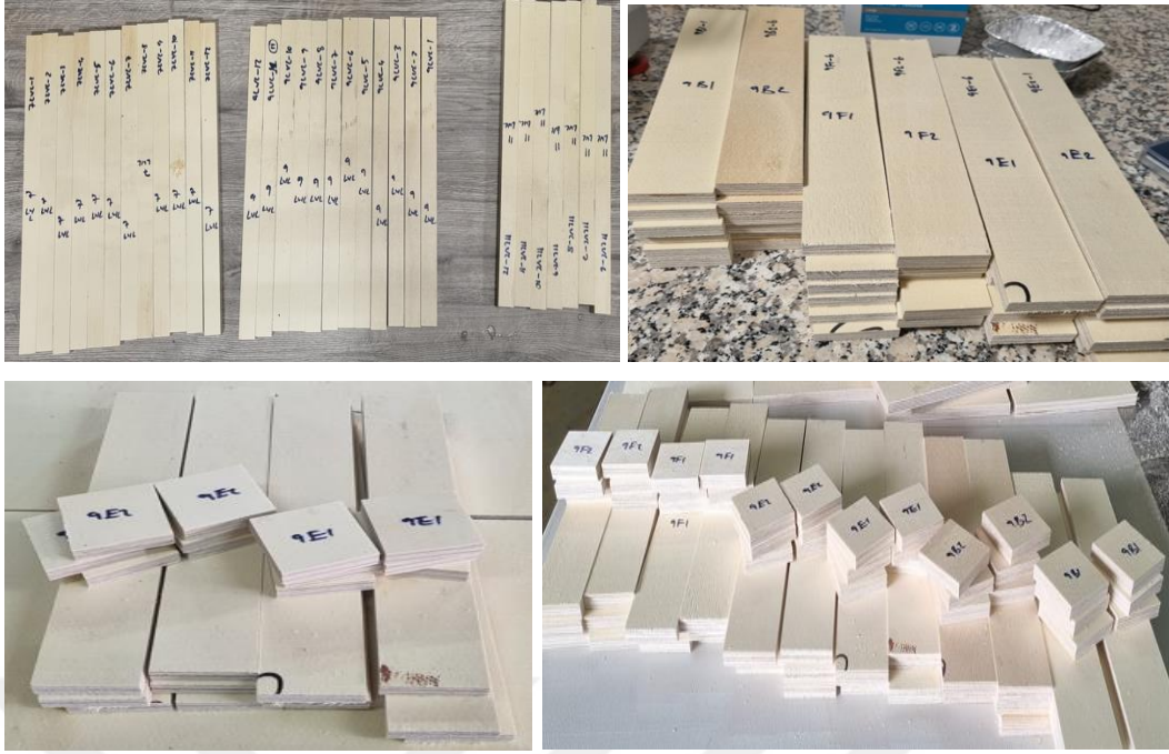
Şekil 3.12: Eğilme ve elastikiyet modülü test örnekleri.
