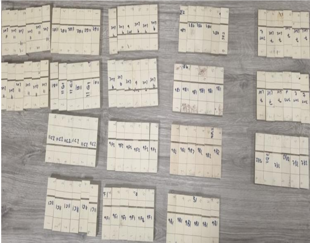
Şekil 3.14: Yapışma direnci test örnekleri.
