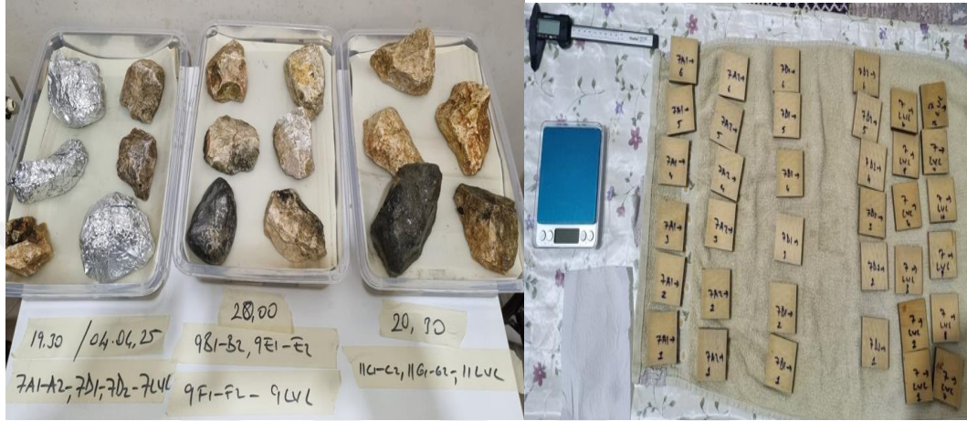
Şekil 3.10: Su alma ve kalınlığına şişme miktarının belirlenmesi.
