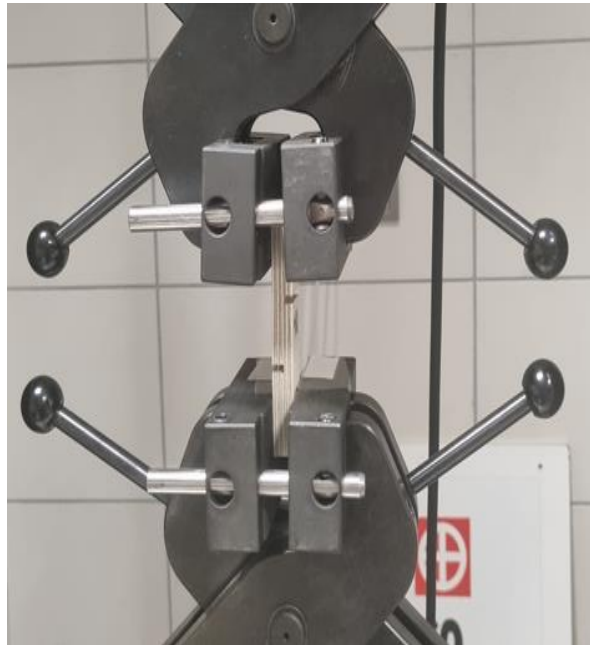
Şekil 3.13: Yapışma direnci testi.
