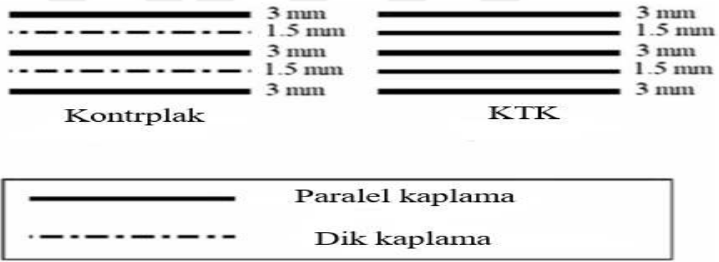
Şekil 2.1: Kontrplak ve KTK’ların tabaka yönlendirmeleri.
