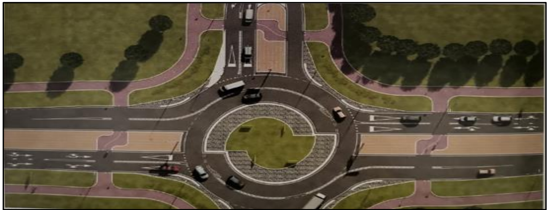
Şekil 2.34. Turbo modern dönel kavşaklar (KGM, 2018).
