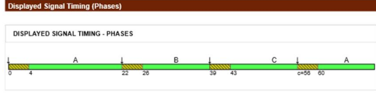
Şekil 3.59: Sidra Optimum Devre Süresi Analizi Sidra Intersection ile Senaryo 2 Trafik Sinyalizasyonu Gösterimi.
