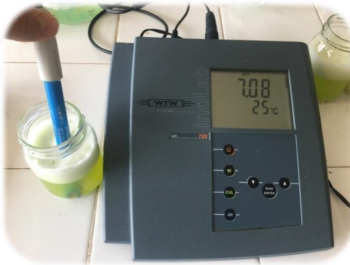
Şekil 19.Meyve suyunda pH ölçümü
