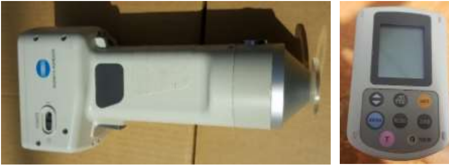
Şekil 3.17. Bitki yaprak rengi ölçümü için kullanılan Konica Minolta Spektrofotometre
