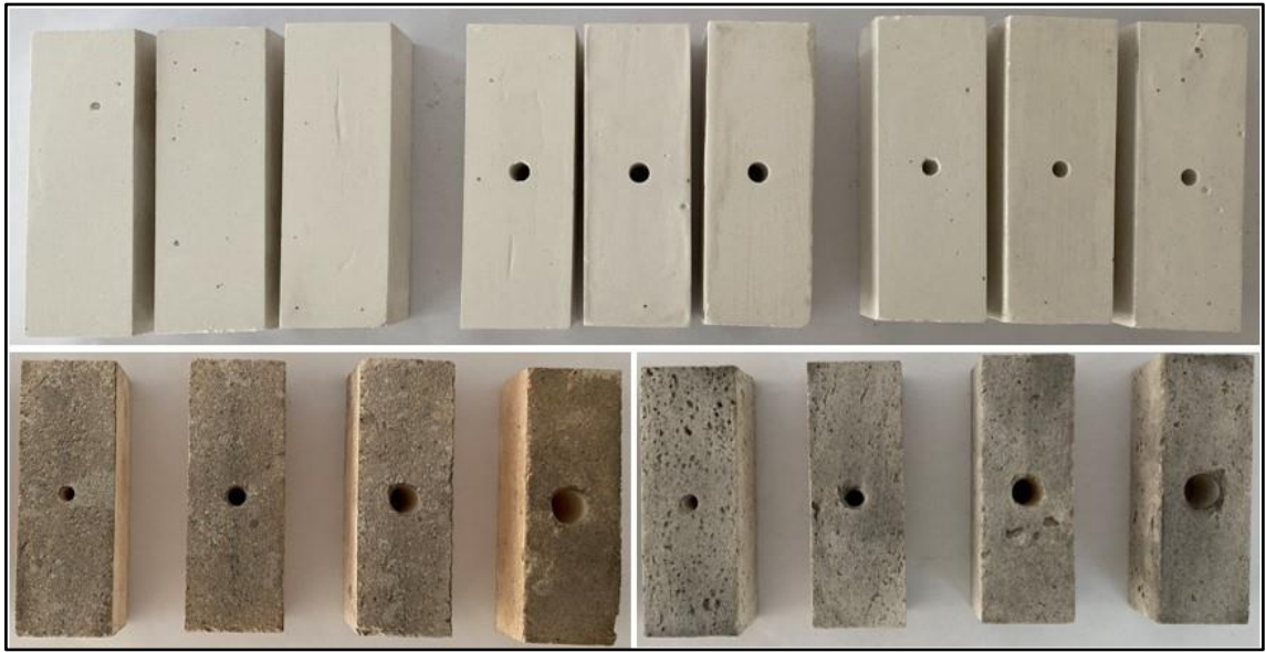
Şekil 3.5. Üzerine delik açılmış prizmatik numuneler.
