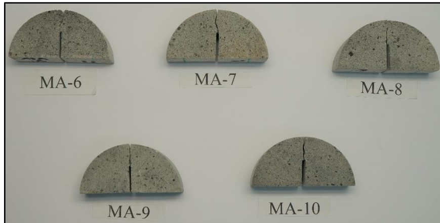
Şekil 4.51. Meram Andezit numunelerinin SCB yarım disk kırılma tokluğu deney sonrası görünümü. Deney öncesi açılan çentiklerden başlayarak ilerleyen çatlamların durumu bu fotoğraflarda gösterilmektedir.
