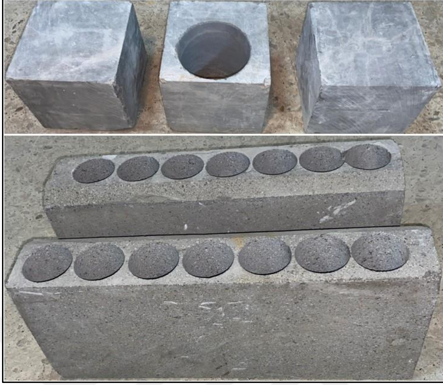
Şekil 3.3. Karot alma işlemi sonrası blok numunelerin görünümü.
