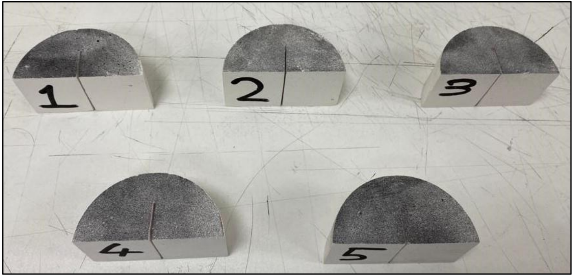
Şekil 4.68. SCB deneyi öncesi yüzeyleri boyanmış çentikli alçıdan yapılmış yapay kayaç numuneleri.
