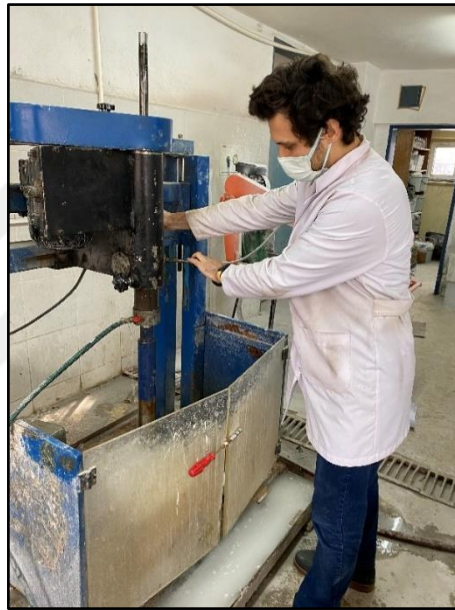
Şekil 4.1. Karot alma işlemi.
