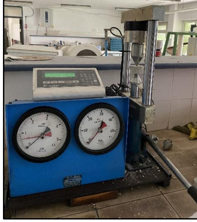
Şekil 4.4. Nokta yükleme deney düzeneği.
