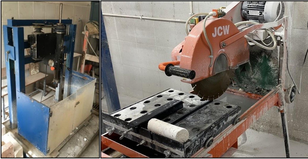
Şekil 3.2. Karotiyer ve Dairesel Testereli Numune Kesme Makinesi.
