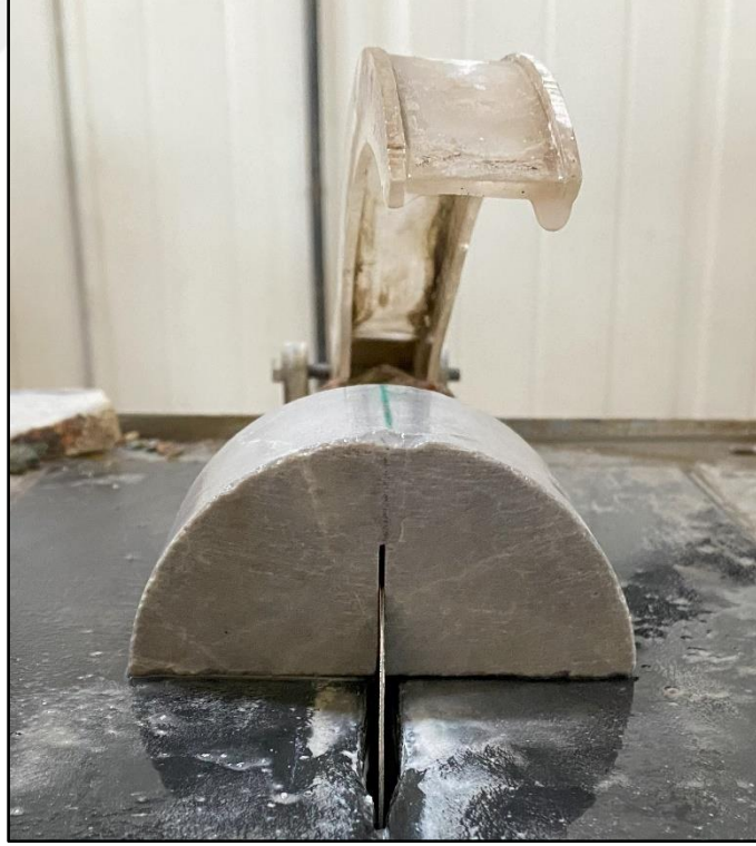
Şekil 3.4. Yarım disk numune üzerinde çentik açma işlemi.
