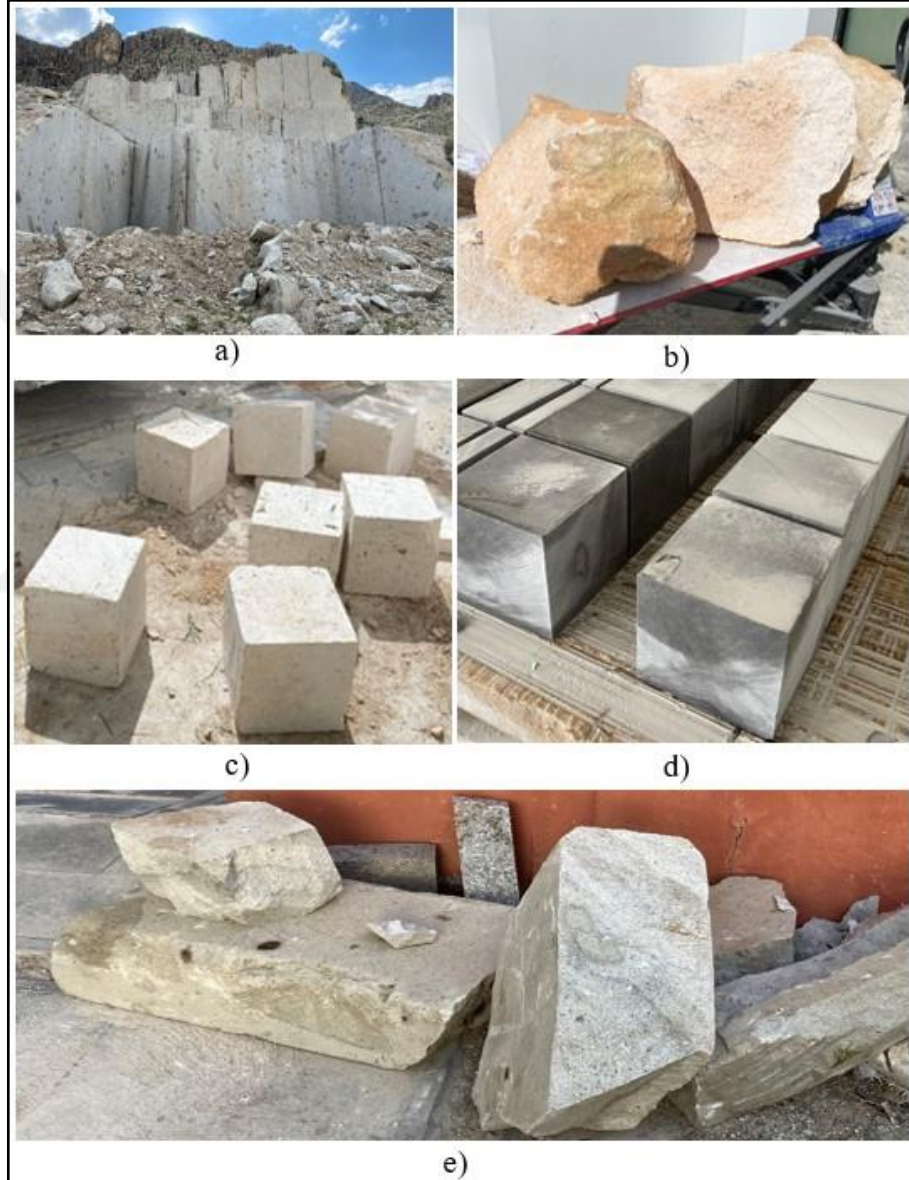
Şekil 3.1. Blok şeklinde maden ocağından ve stok sahalarından temin edilen numunelerin görünümü; a) Meram Andezit ocak görünümü, b) Evliyatekke Tüf numuneleri c) Karaman Traverten numuneleri, d) Afyon Gri Mermer numuneleri, e) Meram Andezit numuneleri.
