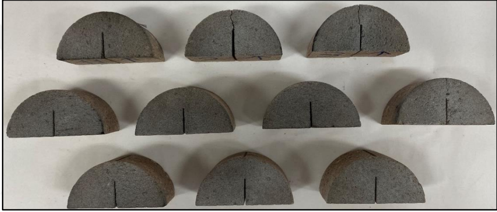
Şekil 4.59. Sille Andeziti numunelerinin SCB yarım disk kırılma tokluğu deney sonrası görünümü.
