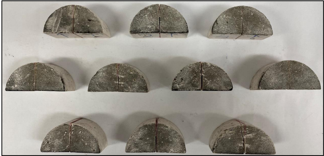
Şekil 4.61. Karaman Traverten numunelerinin SCB yarım disk kırılma tokluğu deney sonrası görünümü.
