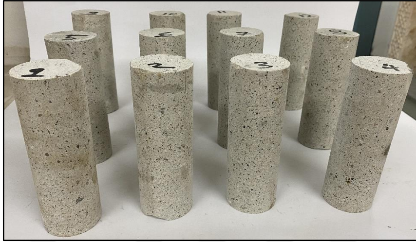
Şekil 4.3. Tek eksenli basınç dayanımı deney numuneleri.
