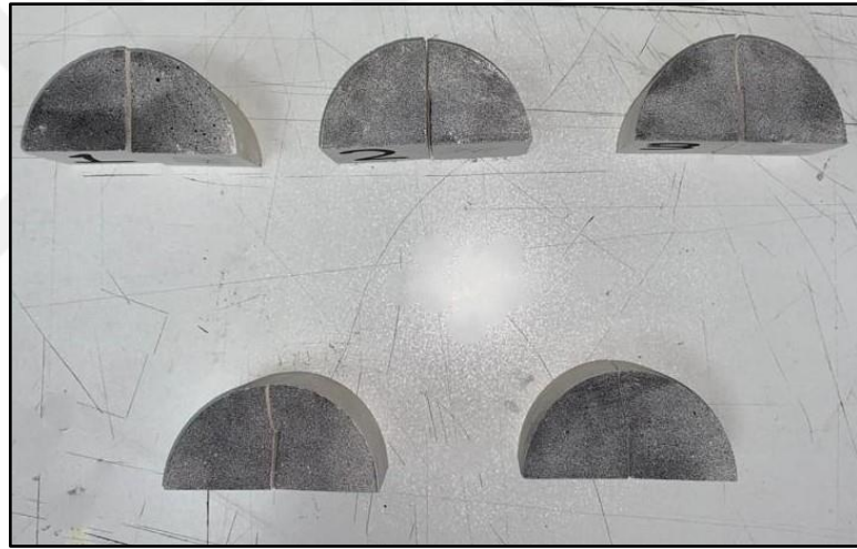
Şekil 4.69. SCB deneyi sonrası alçıdan yapılmış yapay kayaç numunelerin görünümü.
