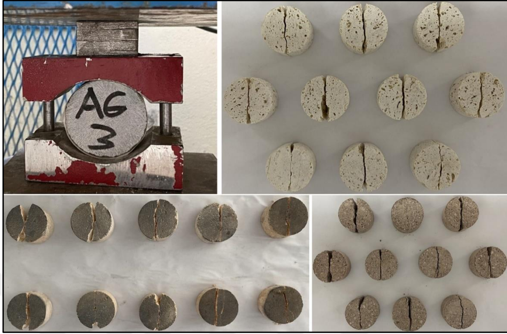
Şekil 4.6. Endirekt çekme dayanımı (Brazilian) deney düzeneği ve deney sonrası numune görüntüleri.
