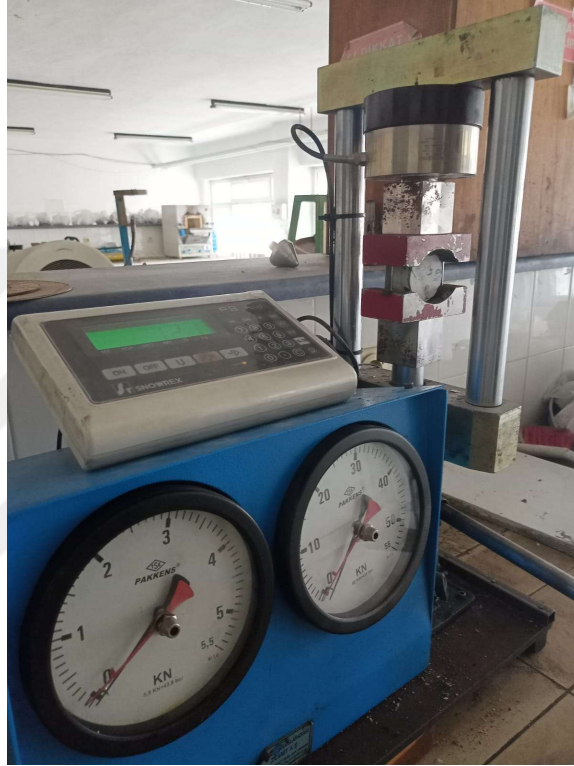
Şekil 3. 6. Brazilian dayanım deneyinin gösterimi
