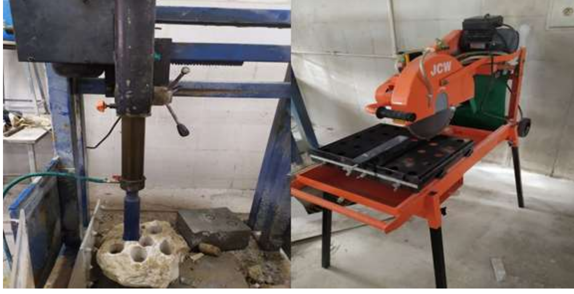
Şekil 3. 2. Laboratuvar ölçekli karot alım makinesi (solda) ve numune kesme-boyutlandırma makinesi (sağda)
