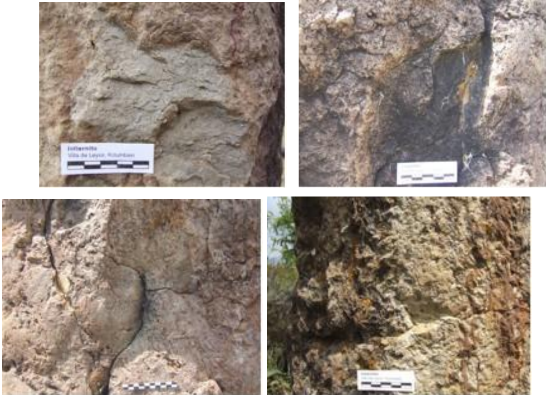
Şekil 4.16. Boyutları mm'den cm'ye kadar değişen dağılma
