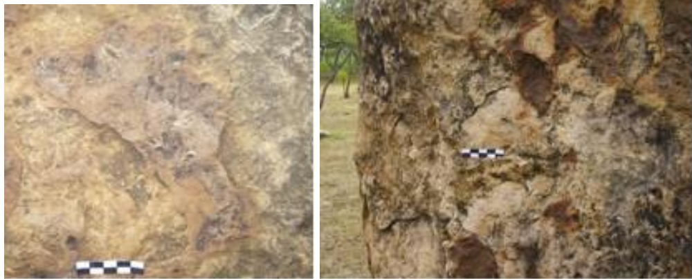
Şekil 4.15. Sıcaklık değişimleri ve kimyasal ayrışma olayları sonucunda kaya kütlelerinin ince katlar halinde taşın yüzeyine paralel levhalar halinde ayrışması
