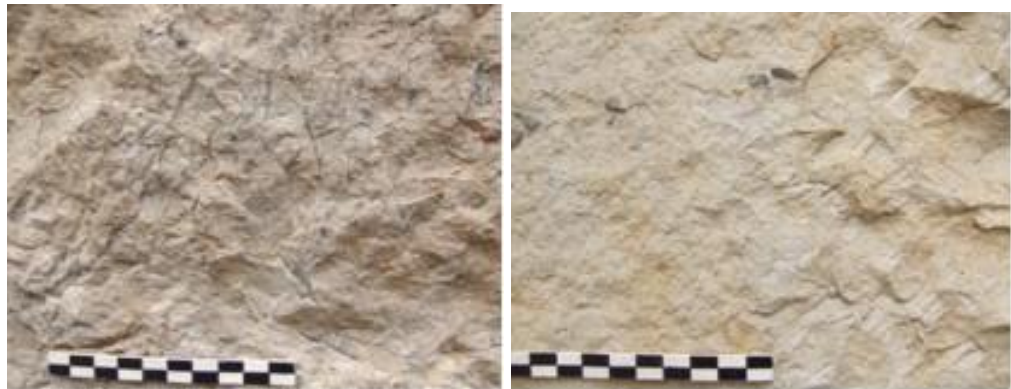
Şekil 4.19. Kilise cephesini oluşturan kumtaşlarının çoğunda gözlenen bir ayrışma şekli olan dağılma
