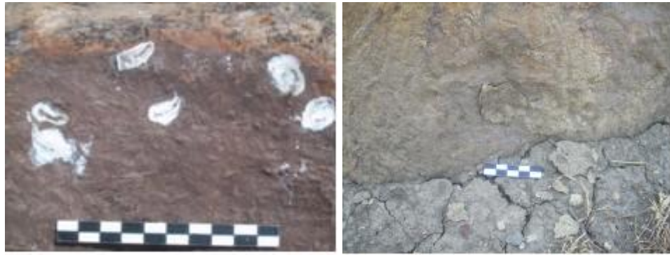
Şekil 4.9. Bazı monolitlerin üzerindeki kuş dışkıları (solda) ile monolitlerin toprakla bulunduğu alt kısmındaki kirlenmeler
