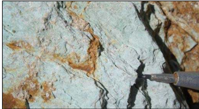
Şekil 3.23 Damdamca Cevherleşmesi kil (kaolinit-montmorillonit-muskovitik illit) alterasyonu (kalemin siyah ucu 3 mm'dir).
