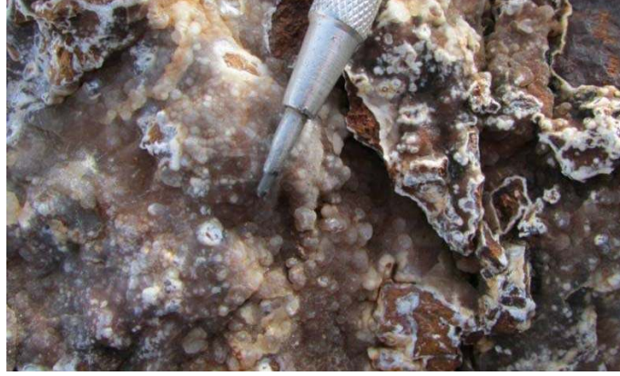
Şekil 3.50 Küçük Mermerlik Tepe Cevherleşmesi'ndeki böbreğimsi yapıda kalsedon damarcığı (kalemin siyah ucu 3 mm'dir).
