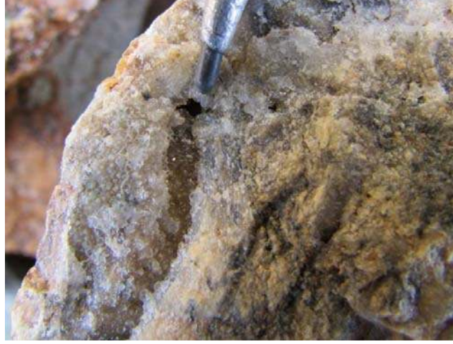
Şekil 3.34 Silisleşmiş-okside serpentinit içerisinde tarak dokusu (kalemin siyah ucu 3 mm'dir).
