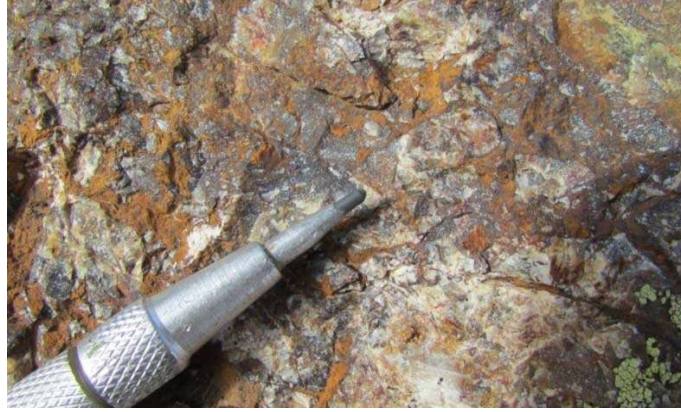
Şekil 3.43 Küçük Mermerlik Tepe Cevherleşmesi silisleşmiş-okside serpentinit (kalemin siyah ucu 3 mm'dir).
