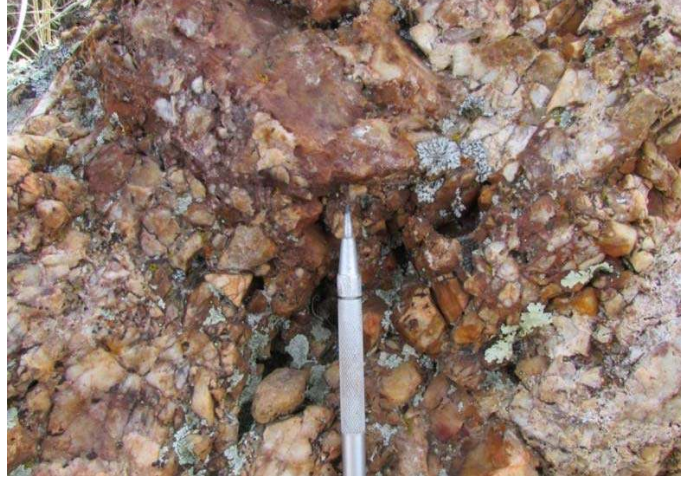
Şekil 3.65 Kızılağıl Cevherleşmesi içerisindeki tektonik breşleşme (kalemin kalınlığı 8 mm'dir).
