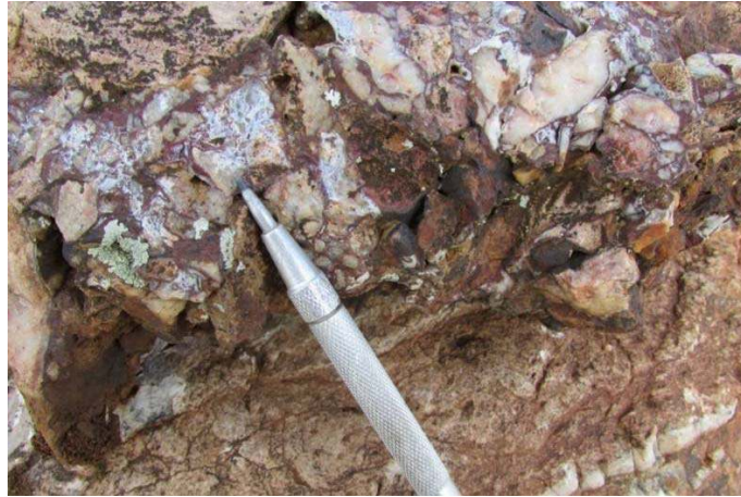
Şekil 3.66 Kızılağıl Cevherleşmesi'ndeki breşleşme ve kalsedon damarları (kalemin kalınlığı 8 mm'dir).
