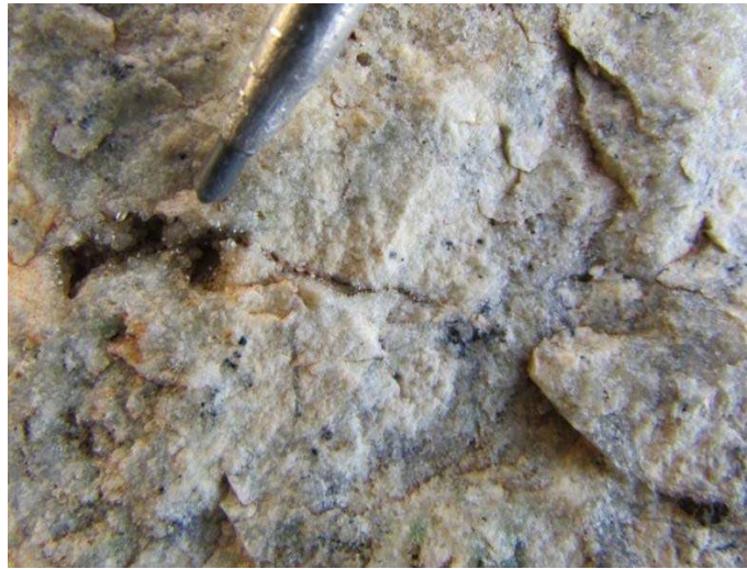
Şekil 3.35 Silisleşmiş-okside serpentinit içerisinde vuggy kuvars dokusu (kalemin siyah ucu 3 mm'dir).
