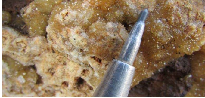
Şekil 3.48 Küçük Mermerlik Tepe Cevherleşmesi’ndeki kalsit sonrası kuvars psödomorfu (kalemin siyah ucu 3 mm’dir).
