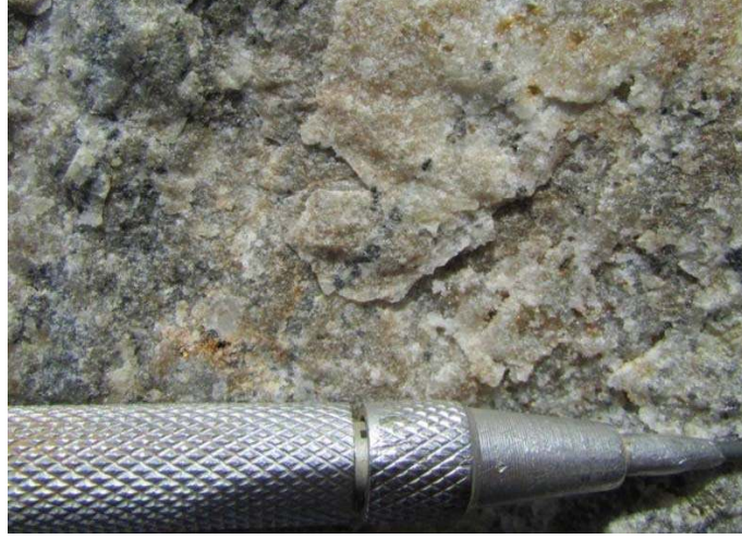
Şekil 3.46 Küçük Mermerlik Tepe Cevherleşmesi'ndeki şeker kuvars dokusu (kalemin kalınlığı 8 mm'dir).
