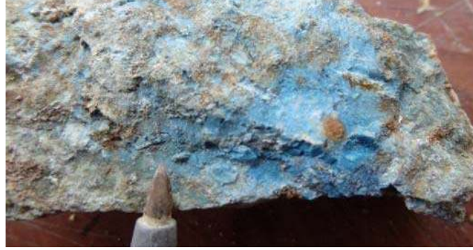
Şekil 3.21 Damdamca Cevherleşmesi kil (kaolinit) alterasyonu (kalemin siyah ucu 3 mm'dir).
