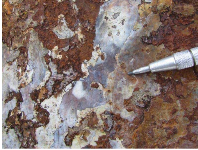
Şekil 3.36 Silisleşmiş-okside serpentinit içerisinde geç evre kalsedon damarları (kalemin siyah ucu 3 mm'dir).
