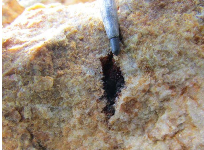
Şekil 3.10 Granitin içersindeki kuvars damarında bulunan vuggy kuvars dokusu (kalemin siyah ucu 3 mm'dir).
