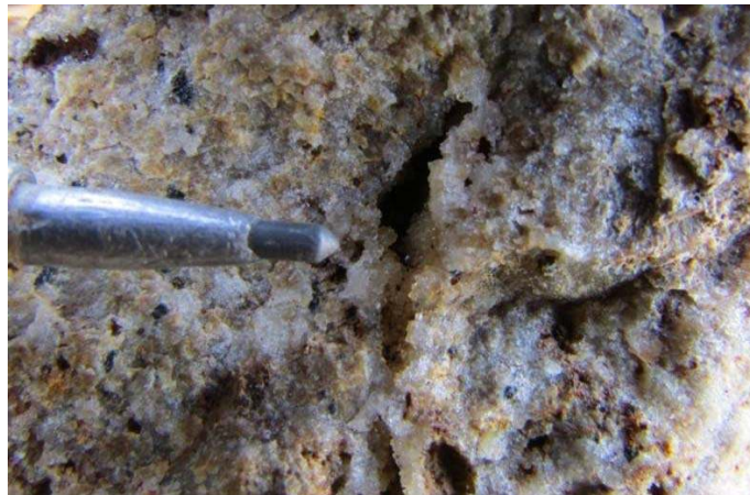
Şekil 3.47 Küçük Mermerlik Tepe Cevherleşmesi'ndeki vuggy kuvars dokusu (kalemin siyah ucu 3 mm'dir).
