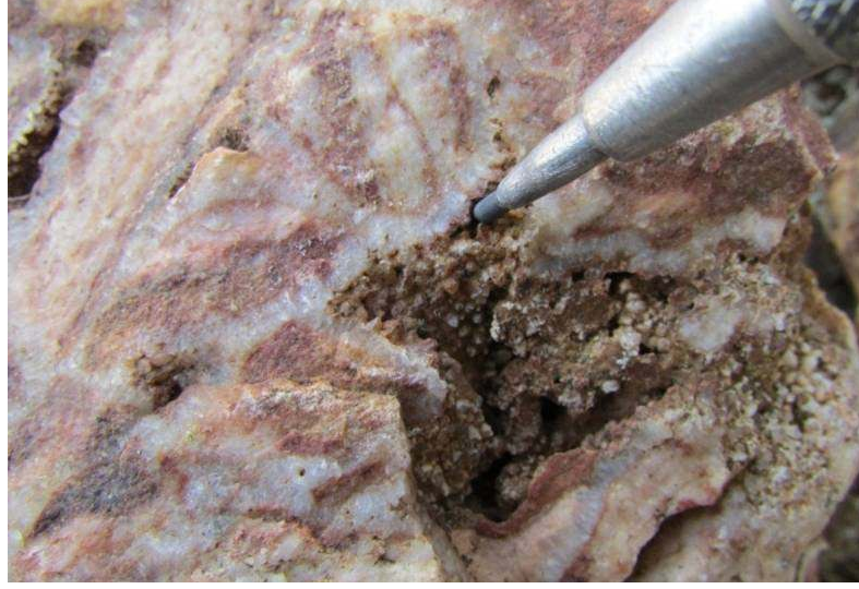
Şekil 3.61 Kızılağıl Cevherleşmesi'ndeki kuvarsın kokard dokusu (kalemin siyah ucu 3 mm'dir).
