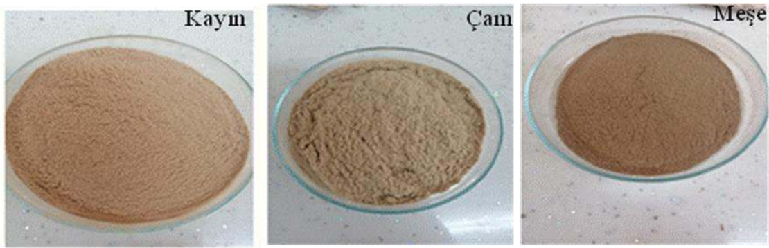
Şekil 5.1. Kayın, Çam ve Meşe ağacı odun tozları (-100 mesh tane boyutu)
