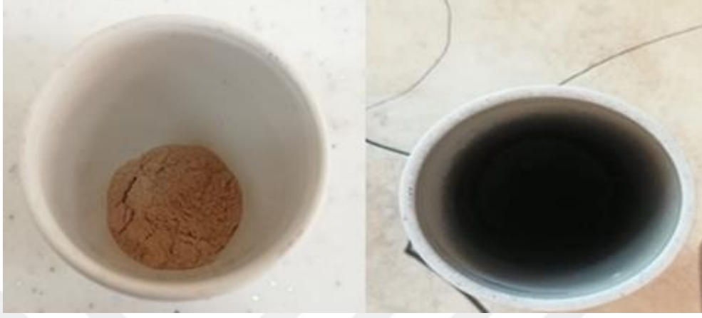
Şekil 5.6. Uçucu madde tayininden önce ve sonra kayın ağacı odun tozunun görünüşü
