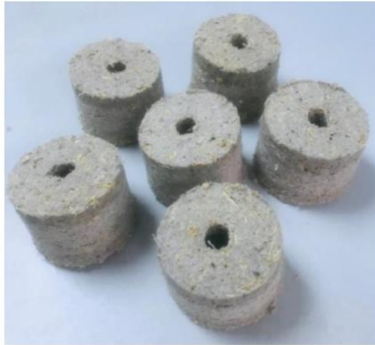
Şekil 3.5. Elle çalıştırılan bir piston presi kullanılarak üretilen briketler [39]
