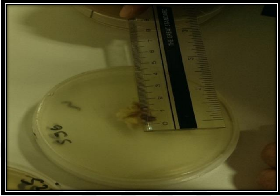
Fotoğraf 3.9. Shiitake mantar misel gelişiminin yatay yönde ölçülmesi
