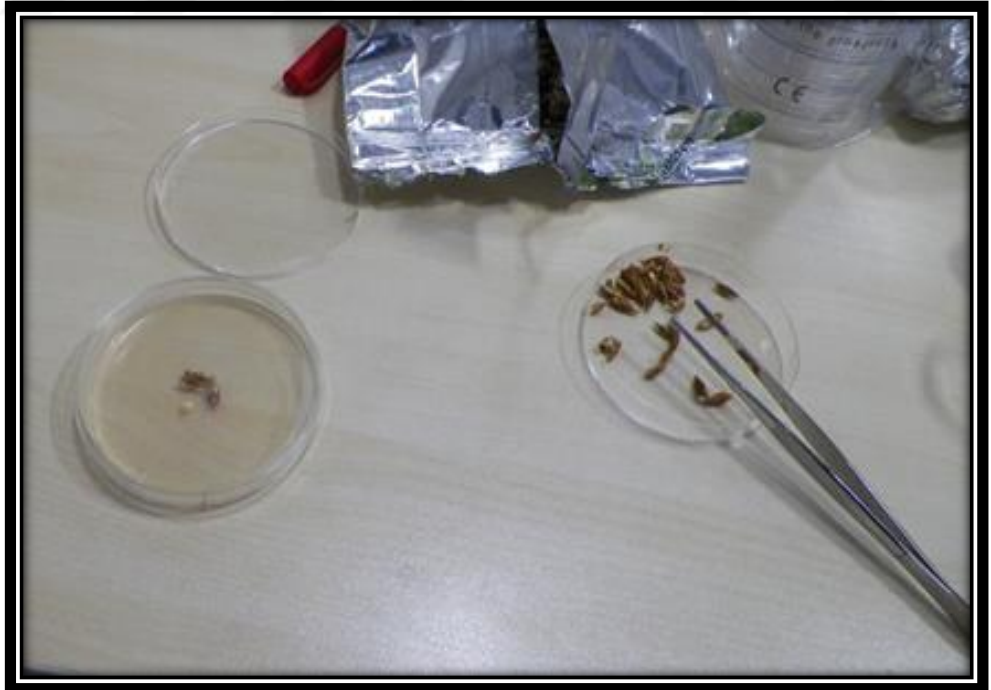
Fotoğraf 3.6. Petri kaplarındaki soğumuş besi ortamlarına misel ekiminin yapılması
