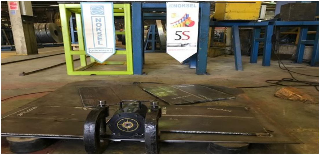
Şekil 5.6. Titreşimle gerilim giderme hazırlık süreci
