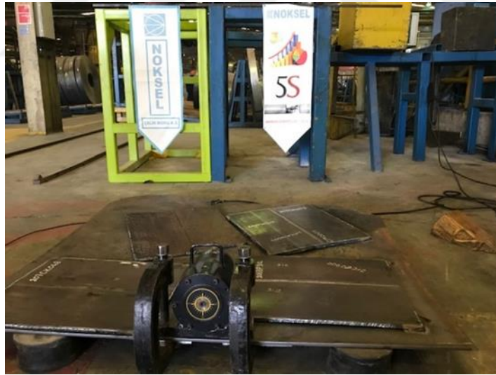
Şekil 6.2. Mekanik titreşim oluşturacak üretelin monte edilmesi
