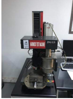
Şekil 6.16. Zwick sertlik ölçüm cihazı
