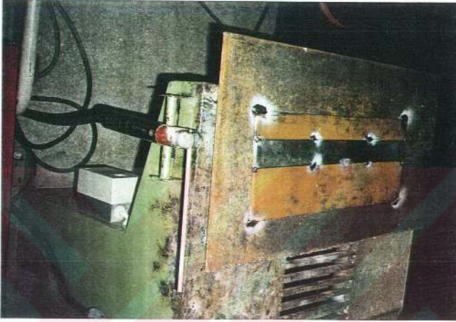
Şekil 4.4. Parçaların puntalanarak emniyete alınması.
