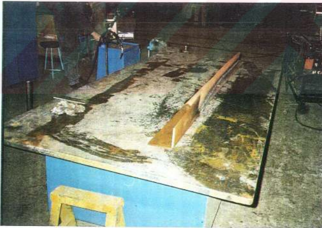
Şekil 4.8. Bir kaynakçı ile tek taraftan yapılan kaynak
