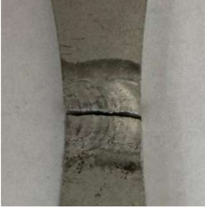
Şekil 3.2 Mekanik testler sonunda kırılan numune görüntüleri
