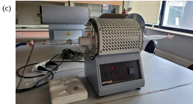
Şekil 3.2: (a) Aktif karbon üretiminde karbonizasyon aşamasının şematik görünümü (b) Aktif karbon üretiminde aktivasyon aşamasının şematik görünümü [105] (c) Aktif karbon üretiminde kullanılan fırın.
