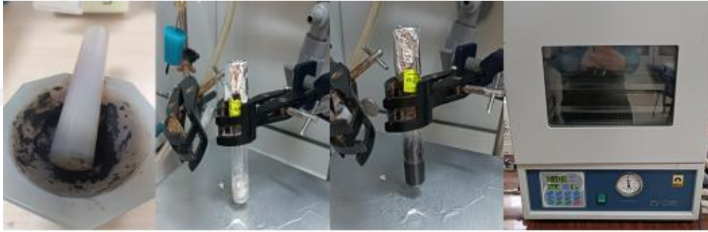
Şekil 3.7: a) agat havanda karıştırılan aktif karbon ve karbon siyahı b) NMP içinde çözünmekte olan pvdf c) NMP içerisinde de çözünmüş pvdf üzerine eklenen aktif karbon ve karbon siyahı d) vakumlu etüv
