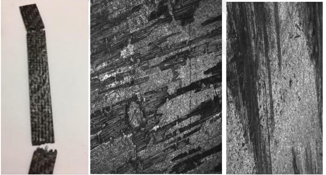
řekil 4.14. 80 °C 'de krlenmiř %10 kayısı ekirdeęi kabuęu tozu katkılı numunenin 5X mikro yapı fotoęrafları
