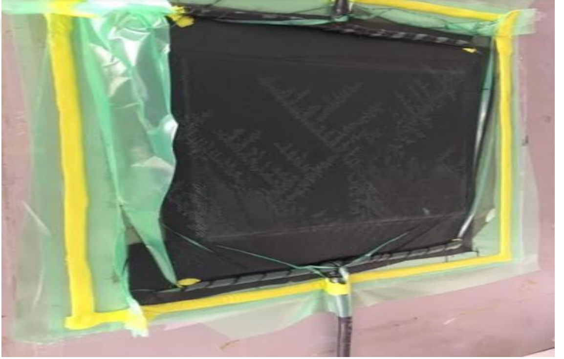
Şekil 3.23. Kayısı çekirdeği kabuğu tozu katkılı karbon elyaf numuneye epoksi reçine-sertleştirici karışımın kalıp içine emdirilmesi ve kürleşme prosesinin uygulanması
