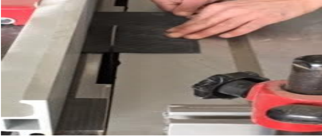
Şekil 3.42. Çekme numunelerinin dairesel testere ile kesilmesi
