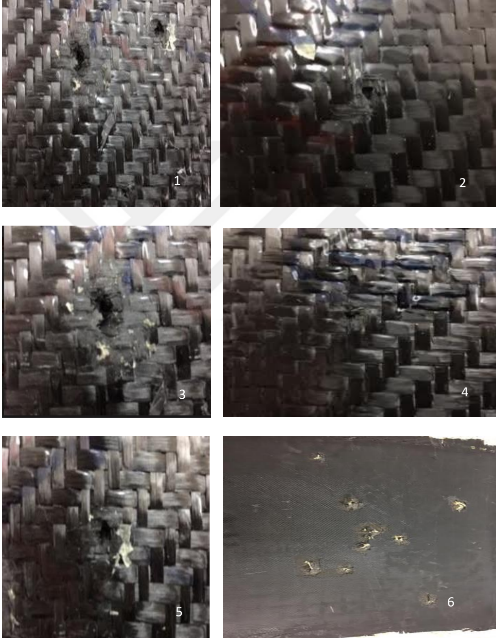
Şekil 4.26. GNFKC numunesinin atış sonuçları
