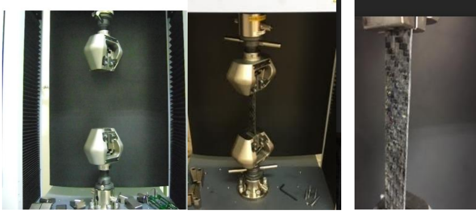
Şekil 3.43. Çekme cihazındaki çekme numunelerine ait fotoğraflar
