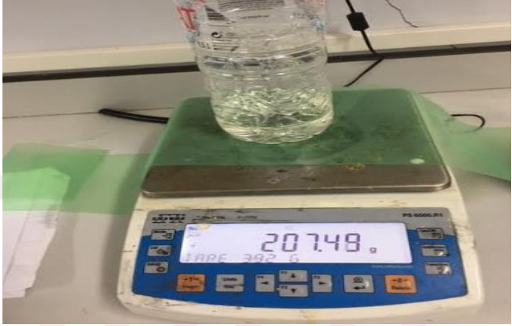
Şekil 3.19. Epoksi reçine ve epoksi sertleştirici karıştırılması
