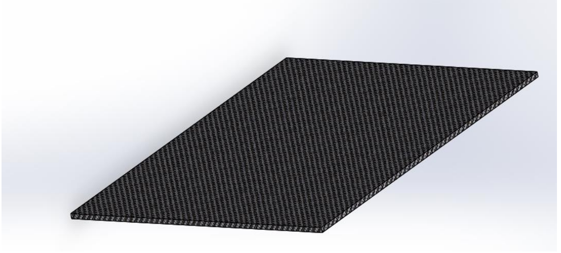
Şekil 3.33. 40 °C ‘de kürlenmiş 5 kat tabakalı epoksi reçine matriksli numune modeli
