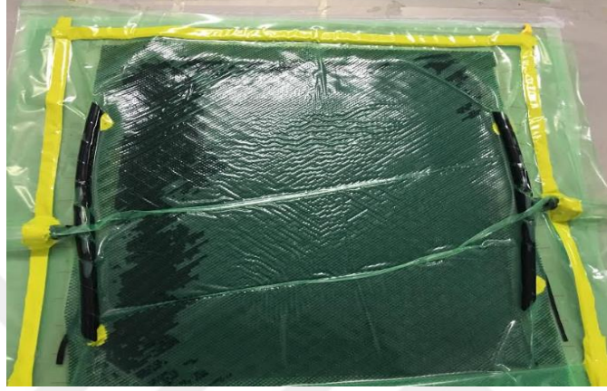
Şekil 2.24. Vakum infüzyon metodu ile üretilen numune
