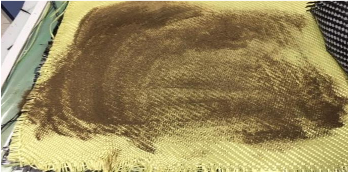
Şekil 3.29. Aramid kumaşa kabuk tozlarının ve grafen malzemesinin uygulanması
