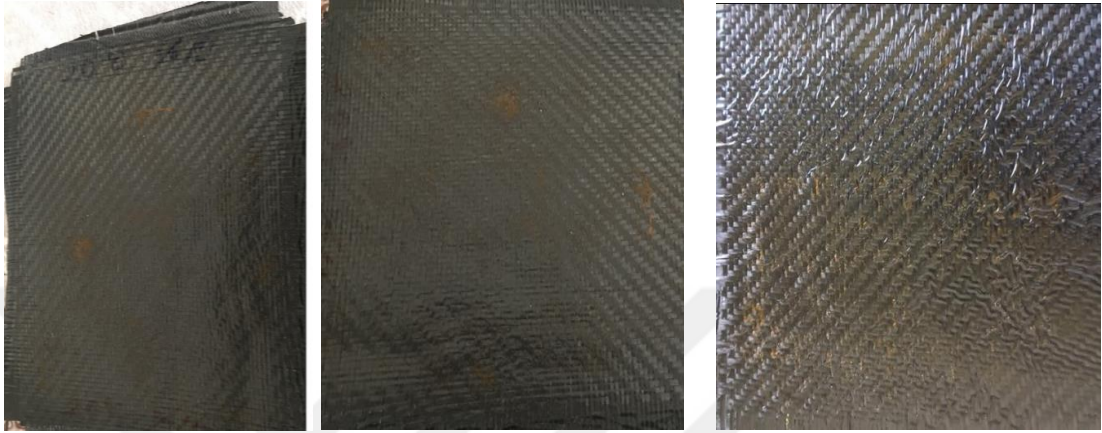
Şekil 3.35. 20 , 60 ve 80 °C değerlerinde kürlenmiş kayısı çekirdeği kabuğu tozu katkılı numuneler
