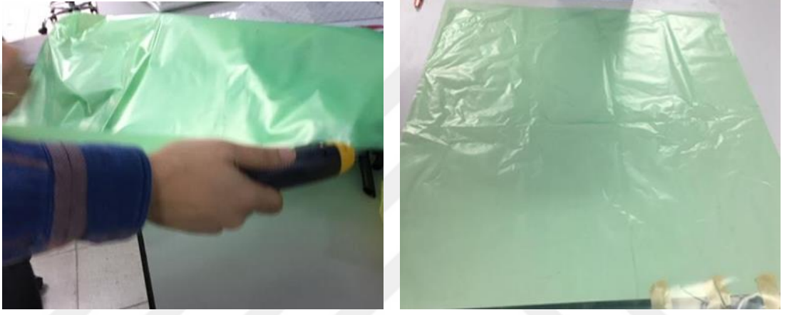
Şekil 3.14. Vakum naylonunun kesilmesi ve serilmesi
