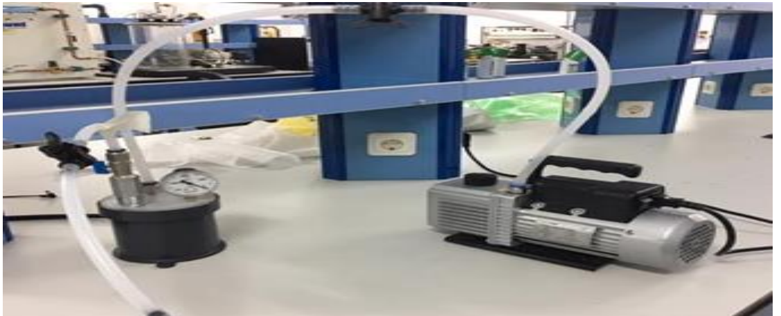
Şekil 3.13. Vakum infüzyon pompası ve kristal toplayıcı
