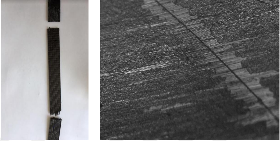
Şekil 4.2. Çekme numunesi ve 5X mikro yapı fotoğrafı
