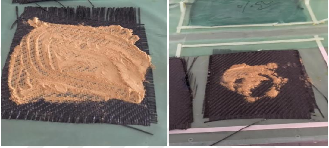
Şekil 3.21. Kayısı çekirdeđi kabuđu tozunun uygulanması
