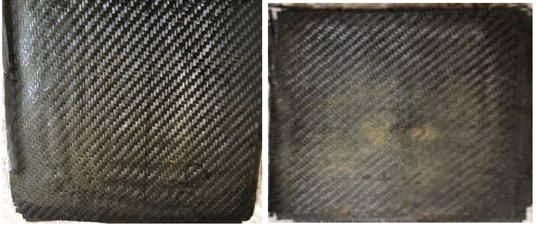
Şekil 3.37. %30 ve % 40 kayısı çekirdeği kabuğu tozu katkılı numuneler
