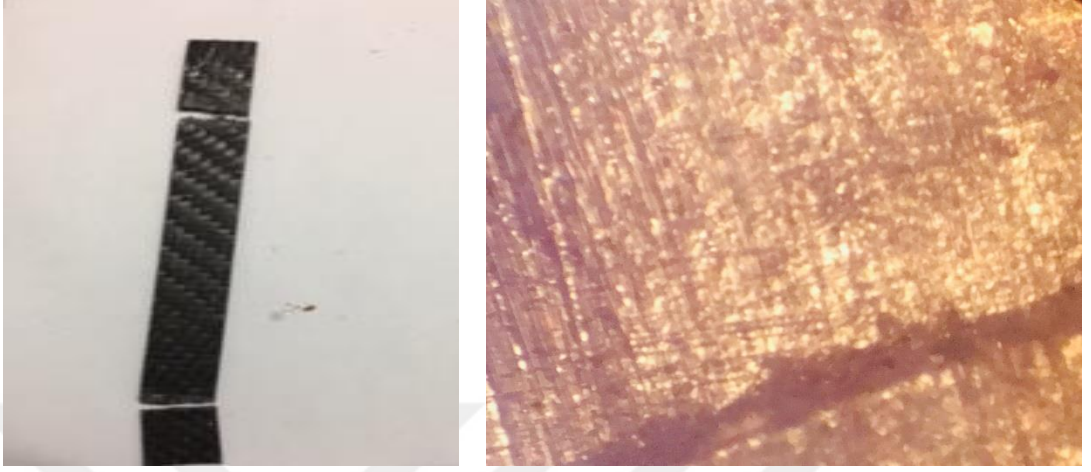
řekil 4.13. 80 °C 'de krlenmiř sade numunenin 20X mikro yapı fotoęrafı
