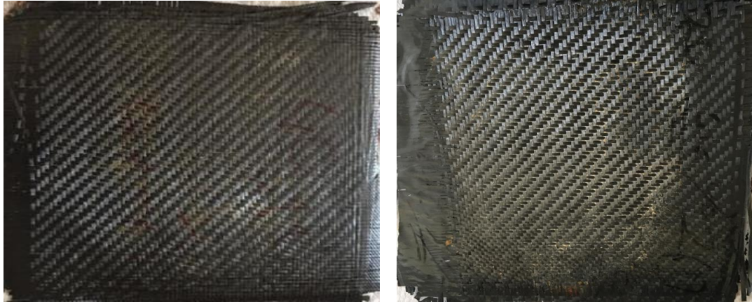
Şekil 3.36. % 10 ve % 20 kayısı çekirdeği kabuğu tozu katkılı numuneler
