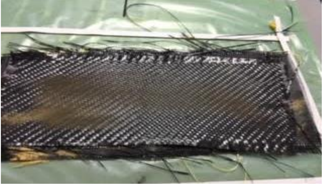
Şekil 3.26. Fındık kabuğu tozunun grafen ile kumaşın üzerine serilmesi
