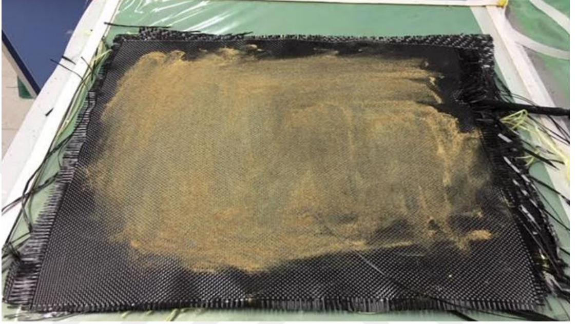
Şekil 3.30. Karbon fiber kumaşa kabuk tozunun ve grafen malzemesinin uygulanması
