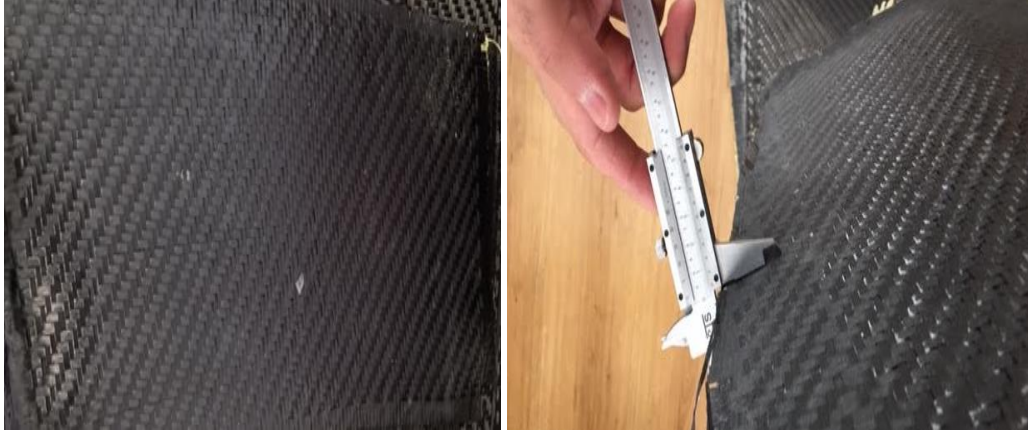
Şekil 3.39. Balistik deneyi için sade grafen nanotozlu üretilen numune
