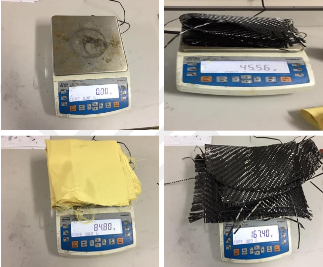
Şekil 3.7. Terazinin kalibrasyonun yapılması ve kesilen kumaşların tartılması
