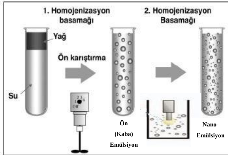
Şekil 3.1. İki aşamalı \alpha -tokoferol nanoemülsiyonu üretimi akım şeması
