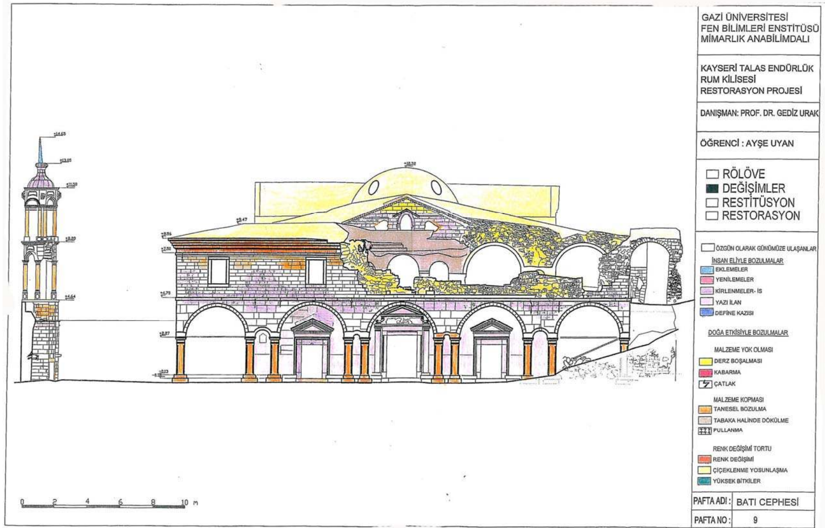
EK-27 Değişim ve bozulmalar batı cephesi
