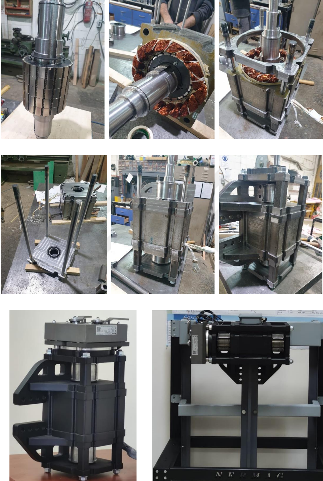
Şekil 4.46. Prototip motor montaj işlemleri
