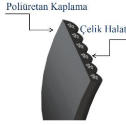
Şekil 2.14. Asansör tahrikinde kullanılan kayışın içyapısı (Demiröz ve ark., 2015)
