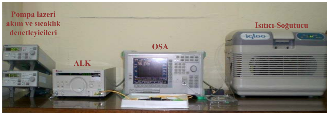
Resim 5.2. Sıcaklığa bağımlı kazanç spektrumu pratik ölçüm düzeneği
