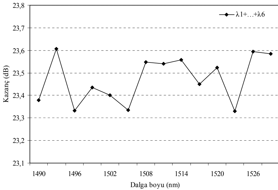
Şekil 4.9. Yakınlaştırılmış S band çıkış kazanç spektrumu
