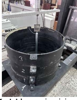
(a) Model kasası içersine kazık yerleştirilmesi
