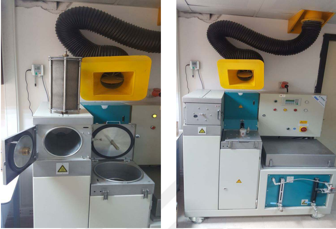
Şekil 12. Ecotest asfalt analizatör cihazı
