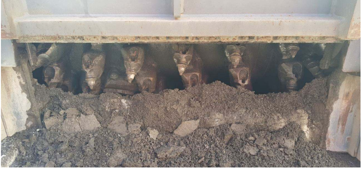
Şekil 9. Kazıma makinesinin kristal uçlu dişleri
