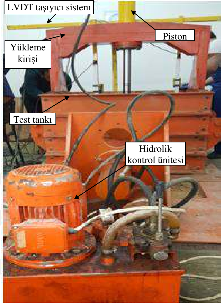
Şekil 23. Tekrarlı plaka yükleme test ekipmanları ve yükleyici sistem
