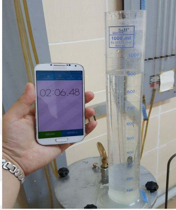
Şekil 22. t zamanda malzemedan geçen su hacminin belirlenmesi
