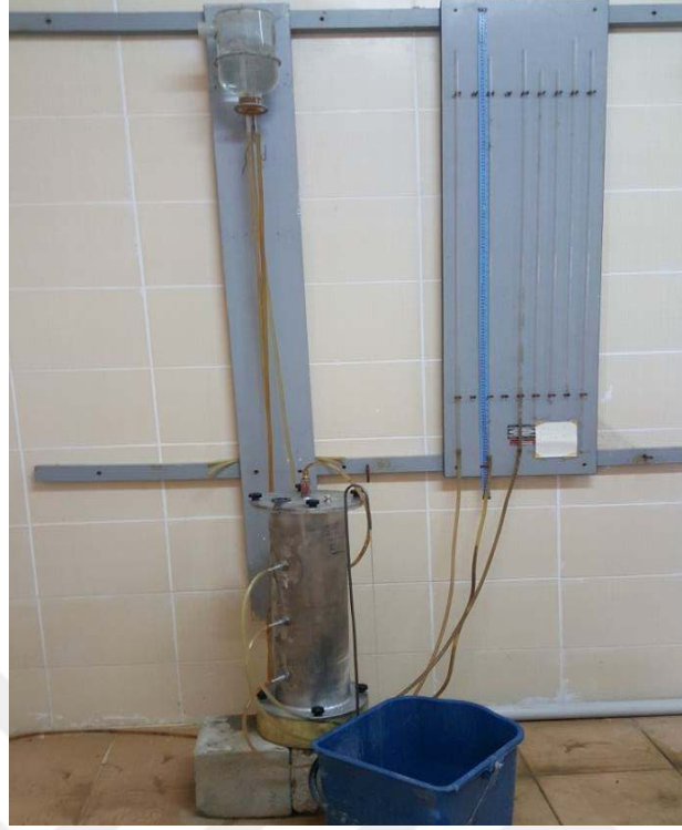
Şekil 20. Sabit seviyeli permeabilite test sistemi
