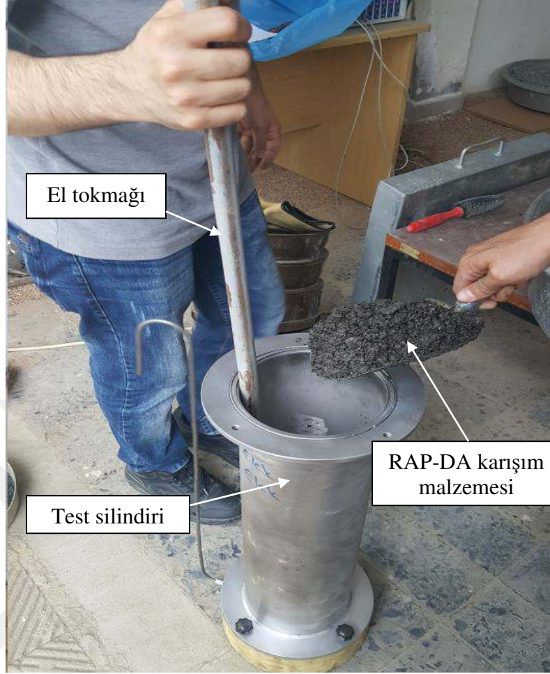
Şekil 19. Malzemelerin silindire yerleştirilmesi ve sıkıştırılması
