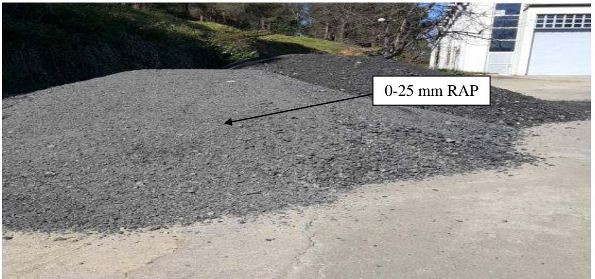
Şekil 10. Depolanan RAP malzemesi
