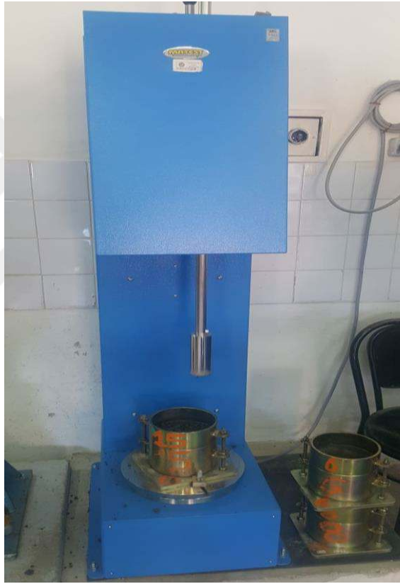
Şekil 13. Numunelerin modifiye proktor ile sıkıştırılması
