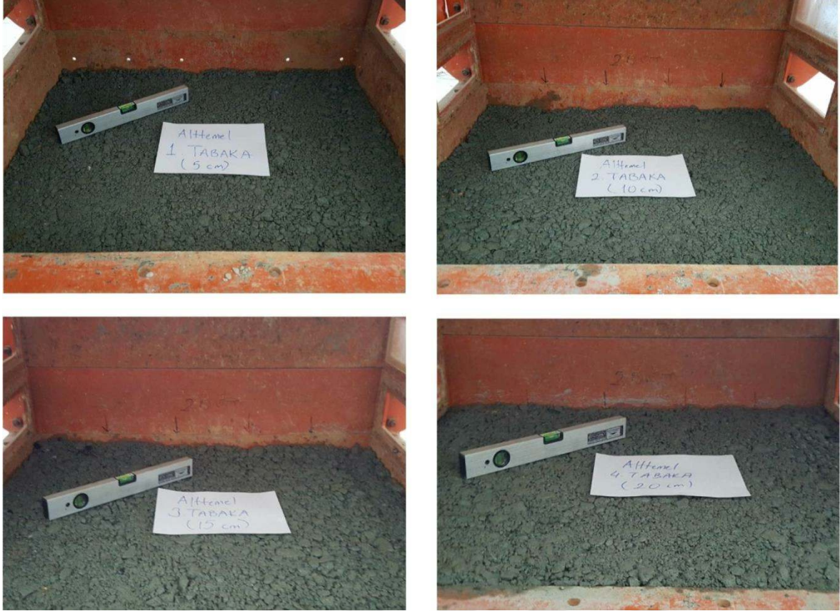
Şekil 27. Tabakalar halinde serilip sıkıştırılmış alttemel tabakası
