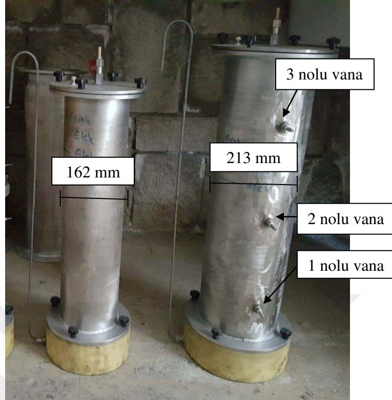
Şekil 17. Sabit seviyeli permeabilite test silindirleri
