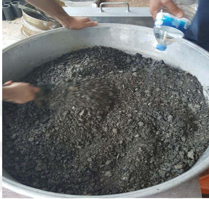
Şekil 18. Permeabilite silindrine konulacak RAP malzemesinin harmanlanması
