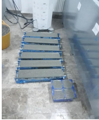
Resim 5.10 Günlük planlanan çalışmalar sonucunda üretilen küp ve kiriş numune betonlar
