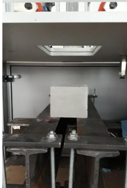
Resim 5.18 Küp numunenin ağırlık düşürme cihazına yerleştirilmesi
