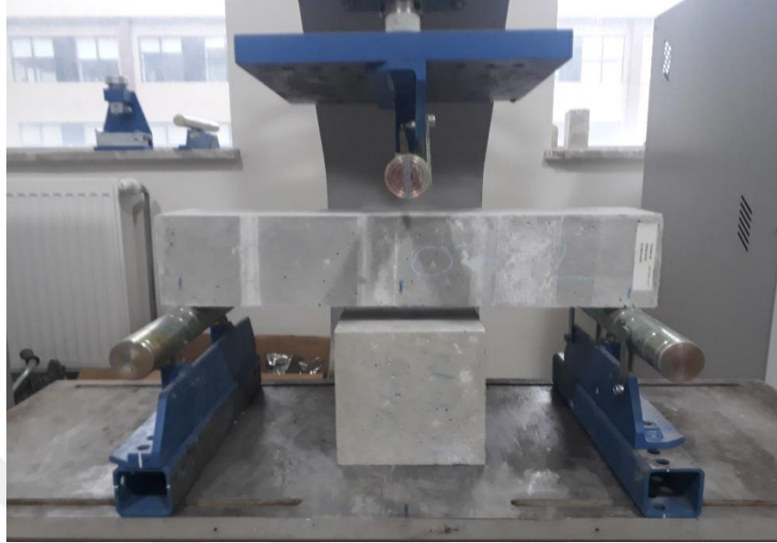
Resim 5.13 Eğılmede çekme deneyi öncesi numunenin düzgün bir biçimde yerleştirilmesi
