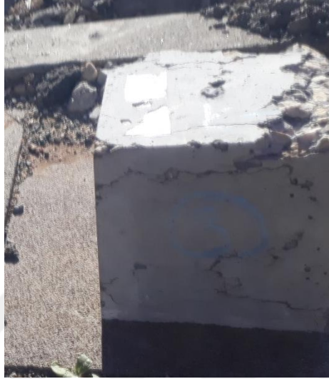
Resim 6.1 kontrol numunesi basınç deneyi sonrası oluşan hasar
