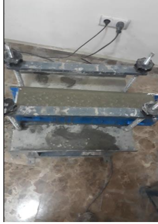
Resim 5.9 Kiriş numunenin vibrasyon masasında sıkıştırılması
