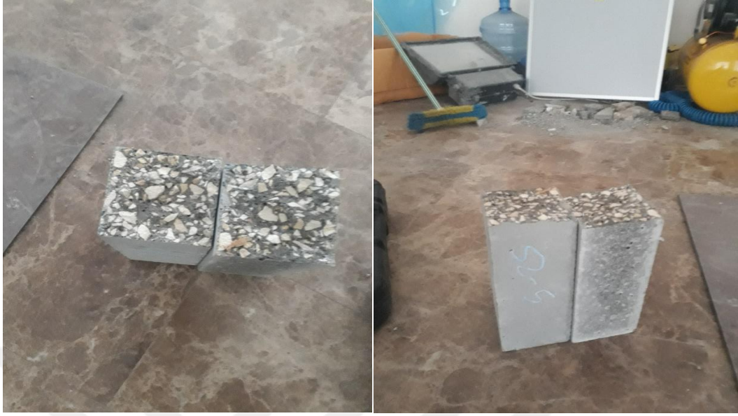
Resim 5.17 Ağırlık düşürme sonucunda kırılan kiriş
