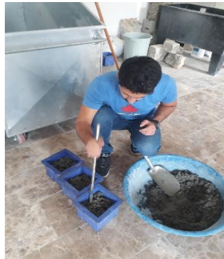
Resim 5.7 Çalışma sonucunda üretilen taze betonun şişlenip sıkıştırılması
