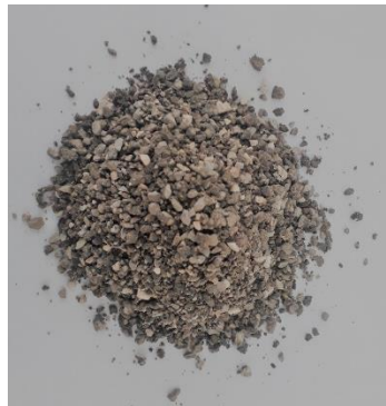
Resim 5.4 Beton karışımlarında kullanılan 0-4 mm kazınmış asfalt malzeme
