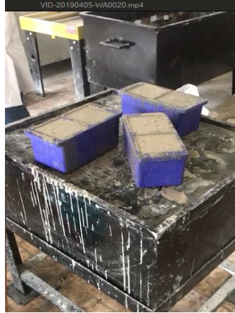
Resim 5.8 Beton numunelerinin vibrasyon masasında sıkıştırılması
