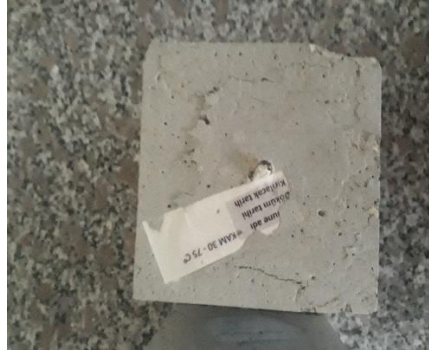
Resim 6.4 %15 kazınmış asfalt içerikli numunenin basınç deneyi sonrası oluşan hasar
