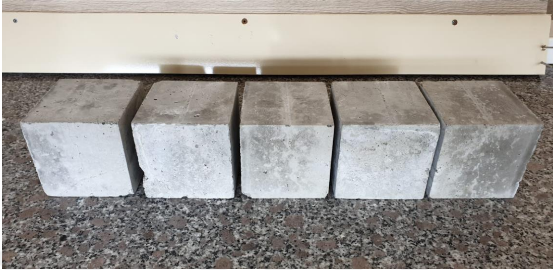
Resim 6.7 50 °C ortam sıcaklığında deneye tabi küp numunelerdeki ağırlık düşürme sonrası hasar (sol başta kontrol numunesi olmak üzere sağa doğru kam oranının artması sonucunda oluşan değişim)
