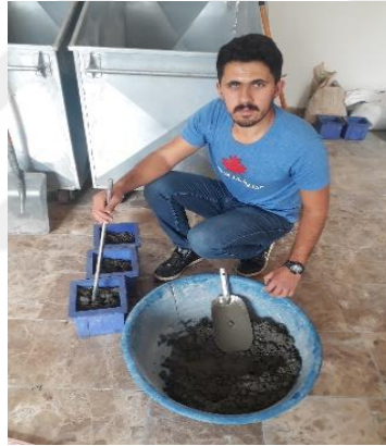
Resim 5.6 Çalışmalarda üretilen taze betonun kalıplara yerleştirilmesi
