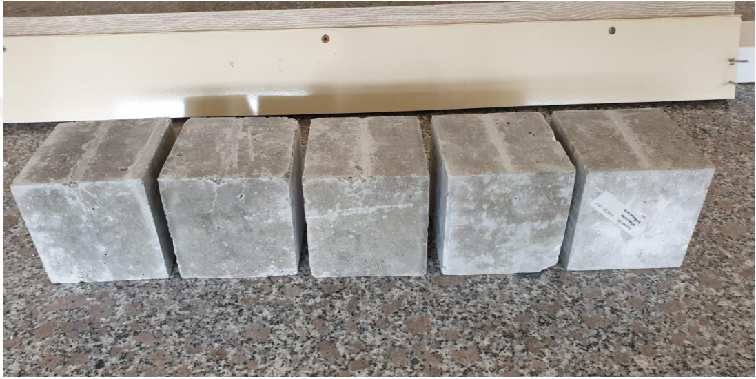
Resim 6.6 25 °C ortam sıcaklığında deneye tabi küp numunelerdeki ağırlık düşürme sonrası hasar (sol başta kontrol numunesi olmak üzere sağa doğru kam oranının artması sonucunda oluşan değişim)
