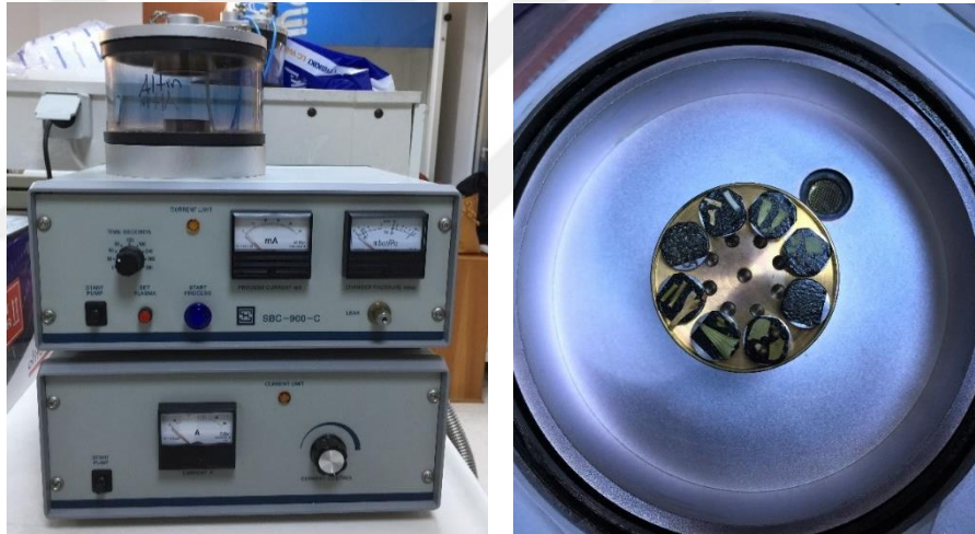
Şekil 3.3. Altın saçtırmalı kaplama cihazı ve hazırlanan örnekler
