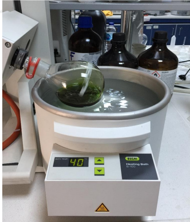
Şekil 3.8. Evaporatör ile alkollü kısmın uzaklaştırılması
